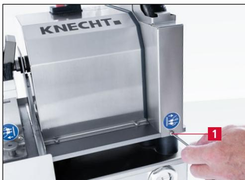
Figure 7-13 Dévisser le capot du disque de polissage
