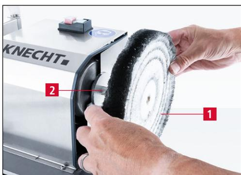
**Figure 7-16** Remplacer le disque de polissage
