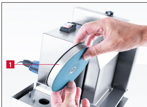
**Figure 7-11** Monter une nouvelle paire de disques d'affûtage
