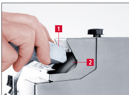
Rys. 7-5 Nakładanie pasty polerskiej
