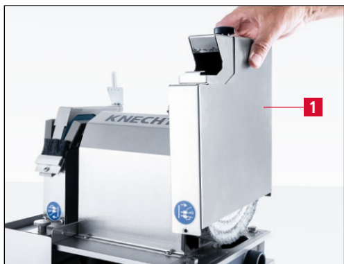
Rys. 7-14 Zdejmowanie pokrywy tarczy polerskiej
