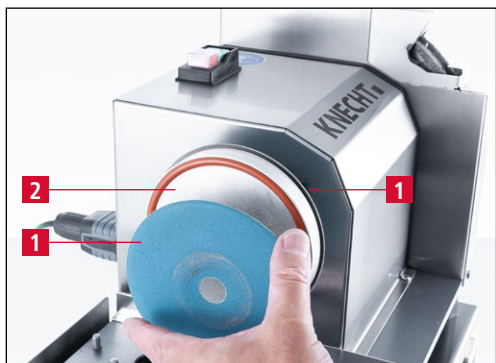
Rys. 7-10 Usuwanie zużytych ściernic
