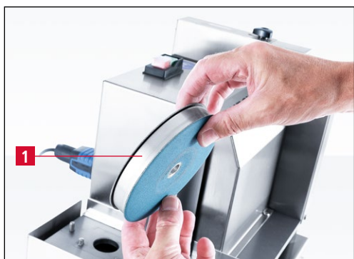
Rys. 7-11 Montaż nowej pary ściernic
