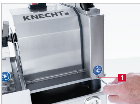
Rys. 7-13 Luzowanie osłony tarczy polerskiej
