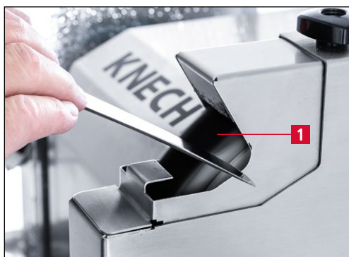
Rys. 7-6 Polerowanie noża ręcznego
