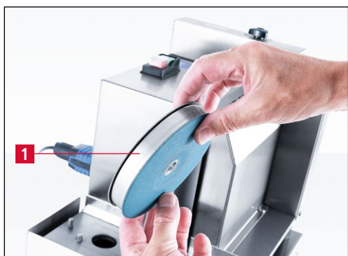
Рис. 7-11 Монтаж новой пары шлифовальных кругов
