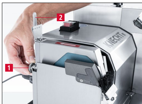
Рис. 7-1 Настройка угла заточки
