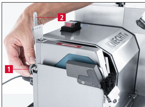
Рис. 7-2 Настройка угла заточки
