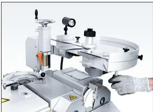
7-11 pav. Diskinio peilio šlifavimo įtaiso pasukimas į fiksavimo padėtį
