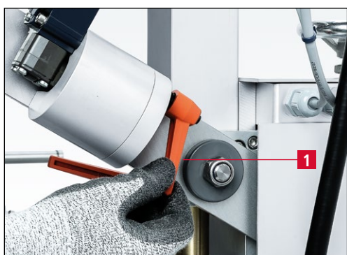
7-61 pav. Prispaudimo svirties „Laikiklio svirtis“ atlaisvinimas
