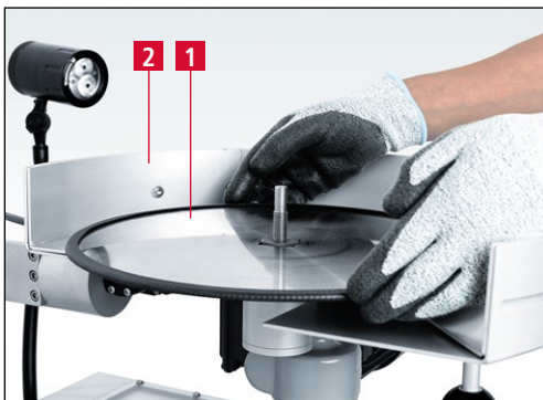
7-15 pav. Diskinio peilio uždėjimas ant laikiklio
