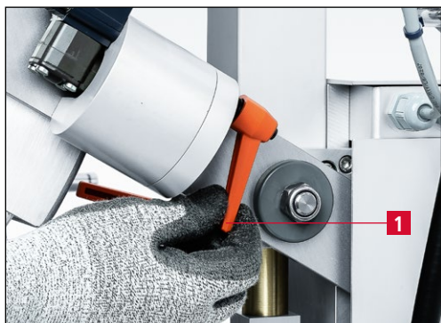
7-20 pav. Prispaudimo svirties „Laikiklio svirtis“ atlaisvinimas
