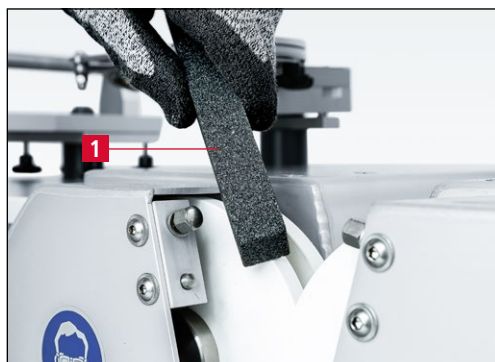
7-89 pav. Šlifavimo diskų užapvalinimas
