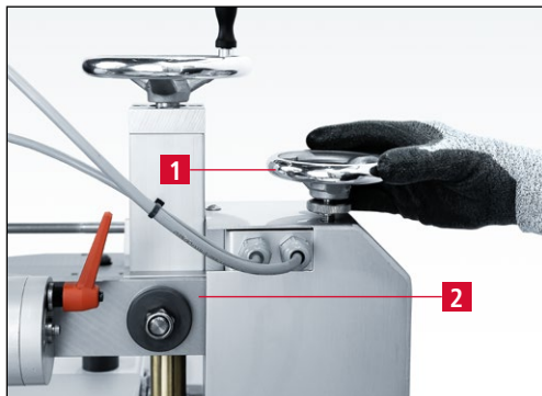
7-23 pav. Laikiklio svirties nustatymas į horizontalią padėtį
