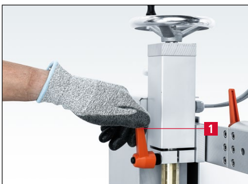
7-65 pav. Prispaudimo svirties „Aukščio reguliavimas“ atlaisvinimas
