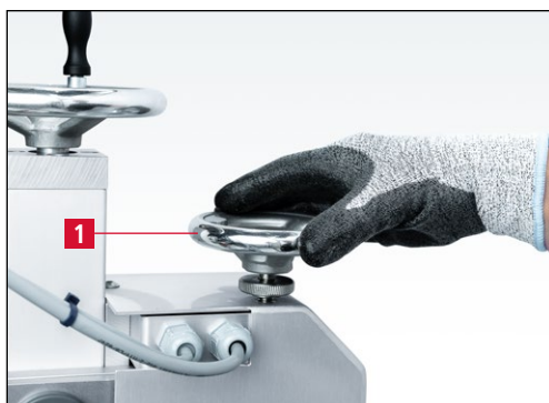
Рис. 7-71 Поворот маховика «Точная подача» против часовой стрелки
