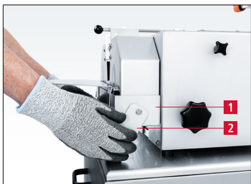
Рис. 7-38 Откидывание поддона для воды
