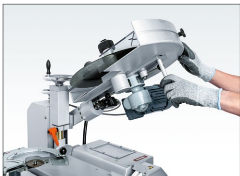
Рис. 7-36 Установка приспособления для заточки дисковых ножей в положение зажима
