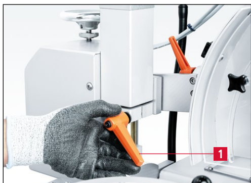
Рис. 7-24 Ослабление зажимного рычага «Регулировка высоты»
