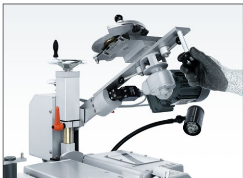
Рис. 7-77 Установка приспособления для заточки круглых ножей в положение зажима
