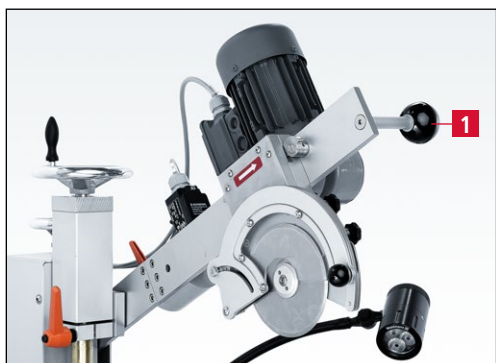
Рис. 7-62 Поворот приспособления для заточки дисковых ножей в положение заточки
