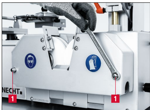
Рис. 7-92 Отвинчивание колпачковых гаек
