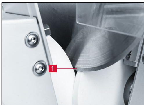
Рис. 7-27 Нож отведен от шлифовальных кругов
