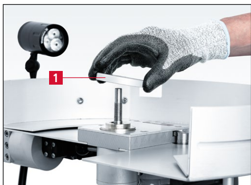
Рис. 7-13 Снятие зажимного фланца
