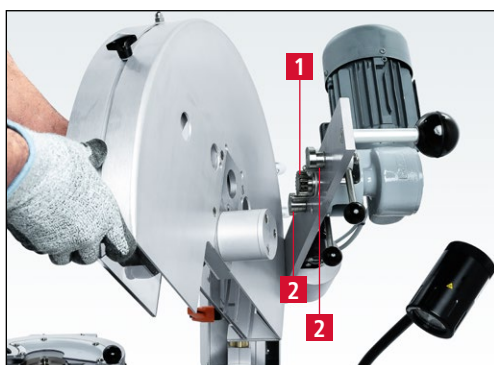
Рис. 7-7 Монтаж крепления дискового ножа
