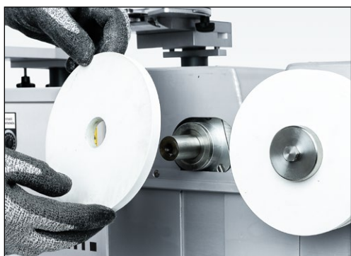
Рис. 7-98 Снятие и замена шлифовальных кругов
