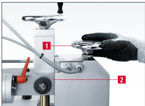
Рис. 7-23 Выравнивание приемного рычага по горизонтали
