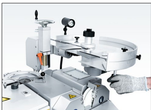
Рис. 7-11 Приспособление для заточки дисковых ножей в позиции зажима
