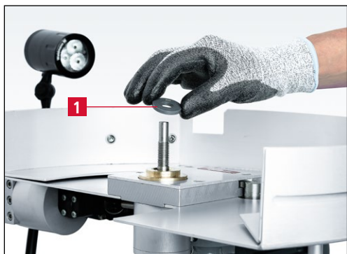
Рис. 7-14 Установка центрирующей шайбы на болт крепления
