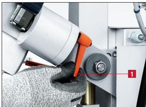
Рис. 7-20 Ослабление зажимного рычага «Приемный рычаг» (7-20/1).
