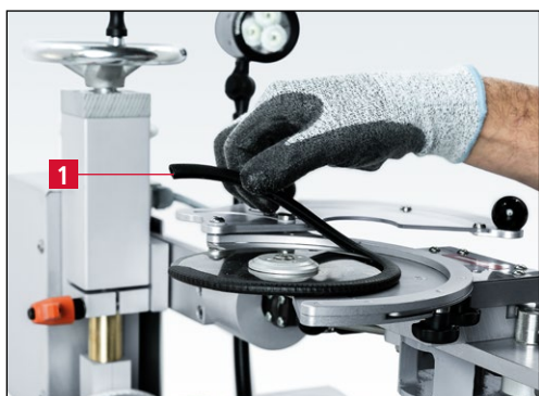
Рис. 7-58 Снятие защиты лезвия
