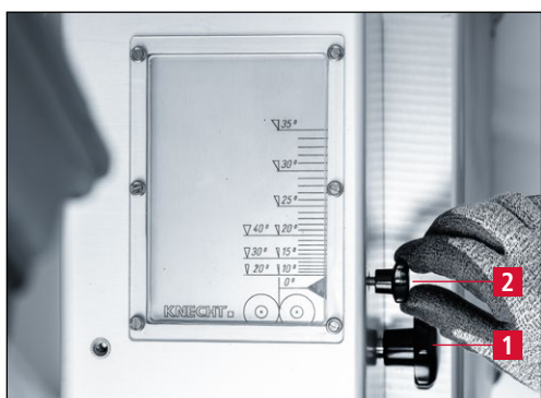
Рис. 7-4 Настройка угла заточки
