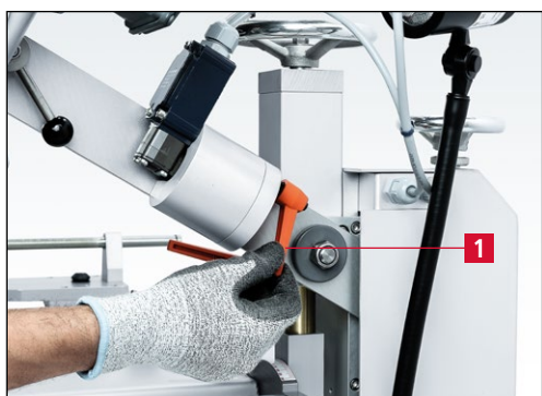
Рис. 7-52 Ослабление зажимного рычага «Приемный рычаг»
