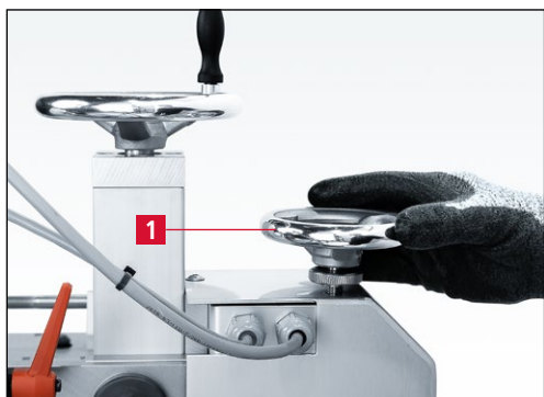
Рис. 7-67 Поворот маховика «Точная подача» по часовой стрелке
