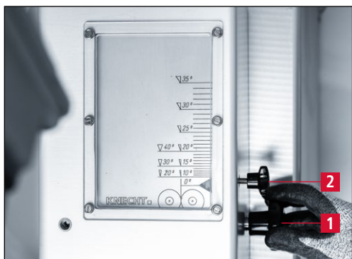
Рис. 7-2 Фиксация стрелки индикатора
