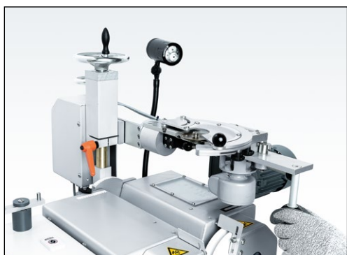
Рис. 7-54 Приспособление для заточки дисковых ножей в позиции зажима
