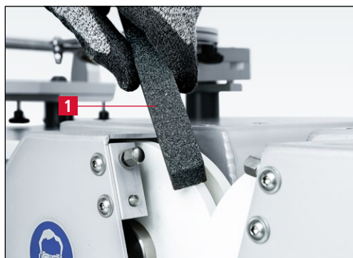
Рис. 7-89 Закругление кромок шлифовального круга
