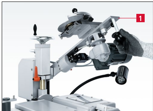
Рис. 7-60 Подъем приспособления для заточки дисковых ножей вверх
