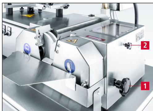
Рис. 7-1 Индикатор угла заточки
