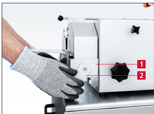
Рис. 7-79 Откидывание поддона для воды
