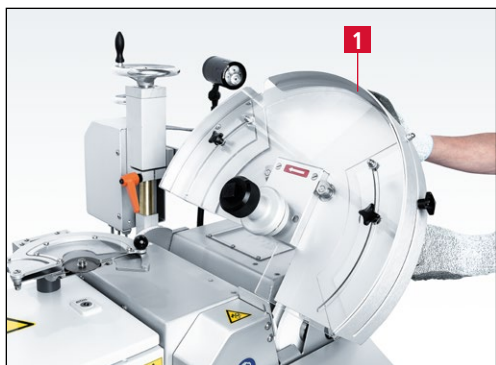
Рис. 7-10 Вращение приспособления для заточки дисковых ножей по часовой стрелке
