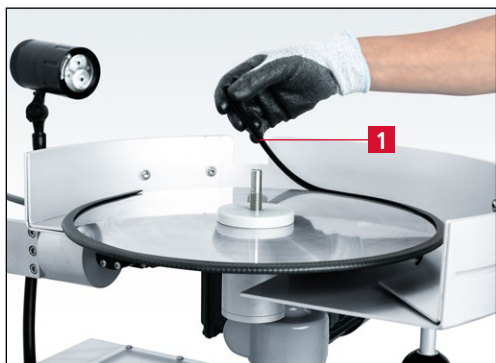
Рис. 7-17 Снятие защиты лезвия
