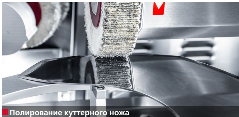
■ Снятие заусенцев с куттерного ножа
