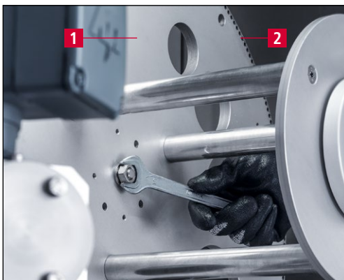
Imagen 7-5 Montar disco de levas
