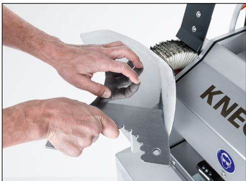
9-50 pav. Atplaišas nuo pjaustymo peilio pašalinkite plokštelių šepetėliu ir nupoliruokite
