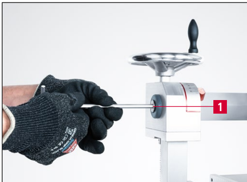
6-1 pav. Pasukimo svirties nuėmimas
