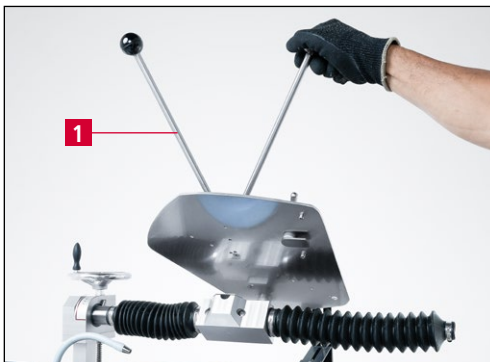
7-39 pav. Šlifavimo plokštės palenkimas atgal
