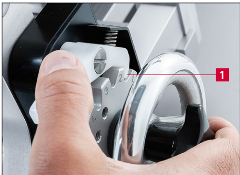
9-22 pav. Tiesaus pjaustymo peilio šlifavimas išgaubiant briauną
