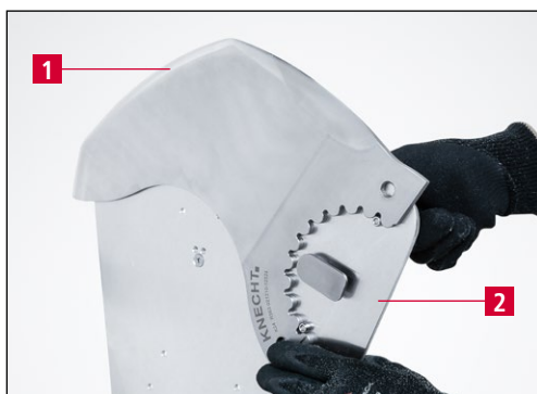
9-36 pav. Peilio priveržimas ant šlifavimo plokštės
