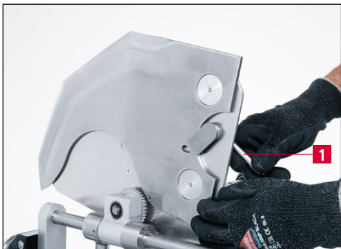
9-10 pav. Peilio fiksavimas ant šlifavimo plokštės
