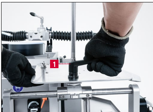
9-18 pav. Suveržimo svirties priveržimas
