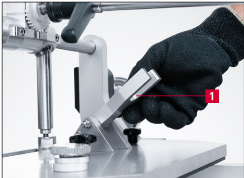
9-1 pav. Vežimėlio fiksatoriaus atlaisvinimas
