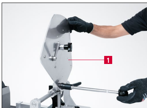
9-35 pav. Šlifavimo plokštės palenkimas atgal į apsaugą nuo pasisukimo
