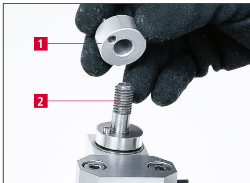
7-33 pav. Tarpinės užmovimas ant laikiklio kaiščio
