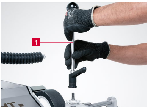
9-2 pav. Suveržimo svirties nuėmimas
