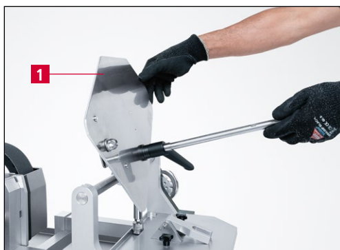
9-8 pav. Šlifavimo plokštės palenkimas atgal
