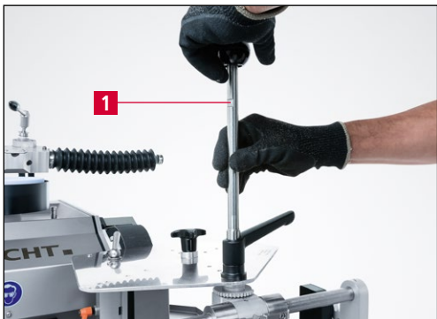
9-32 pav. Suveržimo svirties lengvas priveržimas
