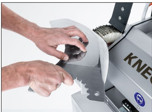
9-26 pav. Atplaišas nuo pjaustymo peilio pašalinkite plokštelių šepetėliu ir nupoliruokite
