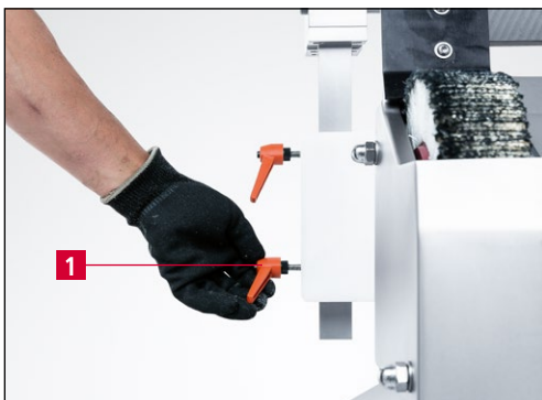
7-13 pav. Peilio nustatymas per šlifavimo plokštės vidurį
