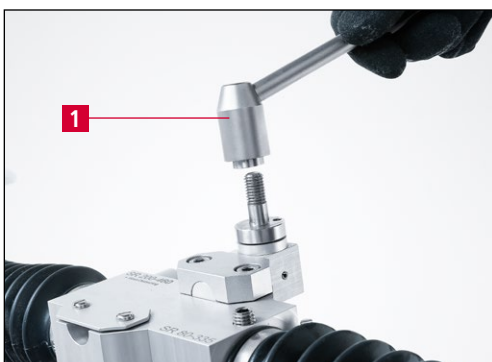
7-4 pav. Suveržimo svirties nuėmimas
