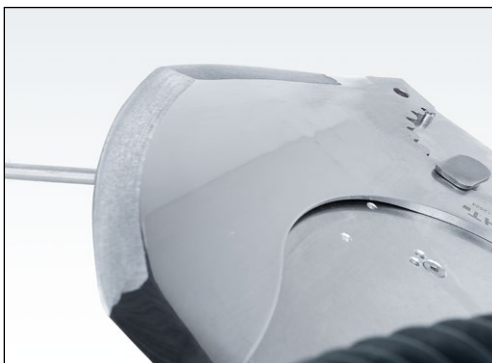
7-50 pav. Pjaustymo peilis, nušlifuotas išgaubiant briauną
