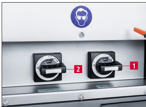
9-19 pav. Šlifavimo mašinos ir aušinimo įrenginio įjungimas
