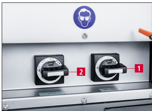
7-19 pav. Šlifavimo mašinos ir aušinimo įrenginio įjungimas
