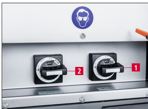
7-22 pav. Šlifavimo mašinos ir aušinimo įrenginio jungimas
