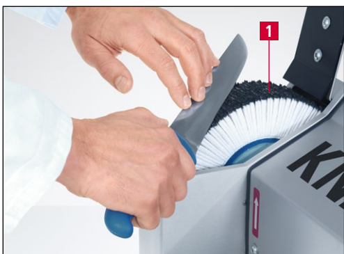
Фиг. 7-8 Премахване на заусенъци и полиране на ръчни ножове
