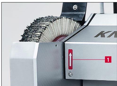
Фиг. 6-2 Проверка на посоката на въртене
