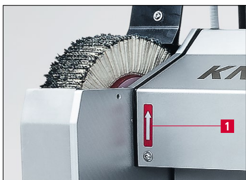
Фиг. 6-2 Проверка на посоката на въртене
