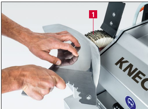
Фиг. 7-6 Премахване на заусенъци и полиране на кутерни ножове
