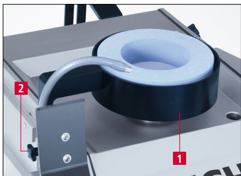
Фиг. 7-11 Настройване на предпазителя на заточващия диск
