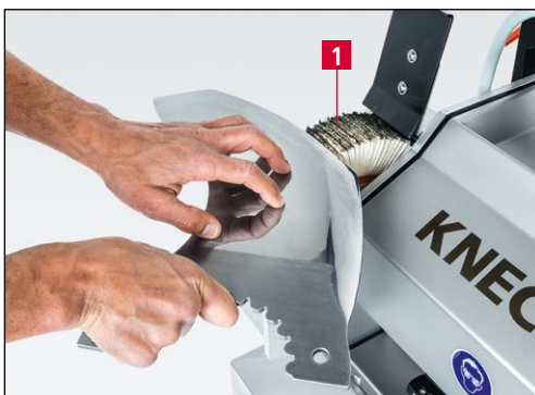
Obrázek 7-6 Odstranění otřepů a leštění kutrového nože
