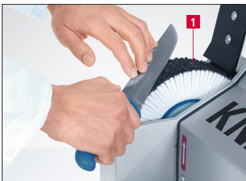
Obrázek 7-8 Odstranění otřepů a leštění ručního nože
