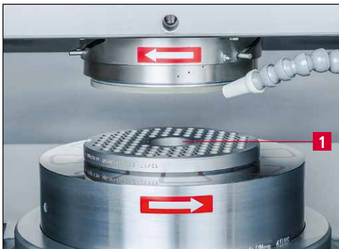
Obr. 7-15 Kotouč do masového mlýnku na otočný stůl
