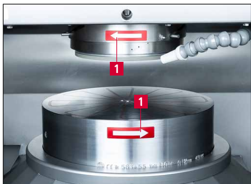
Obr. 6-3 Kontrola směru otáčení
