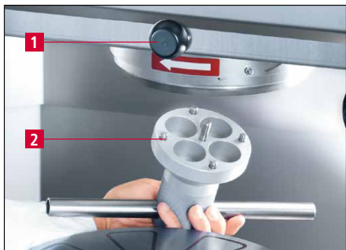
Obr. 7-18 Výměna brusného pásu
