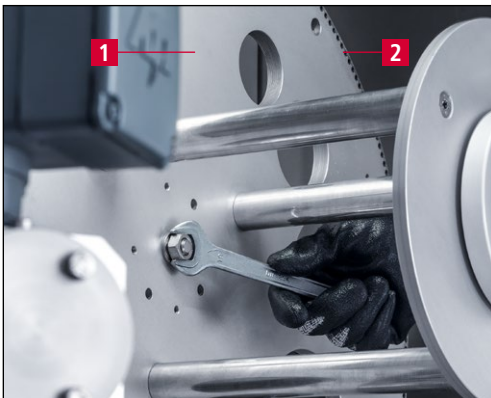
Bild 7-5 Kurvenscheibe SP 116 montieren
