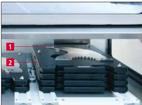
Bild 7-7 Messer auf Ablageplatten
