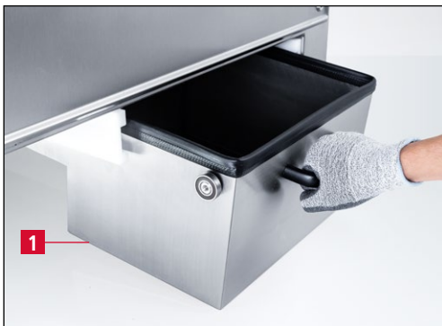
Bild 9-2 Schublade Absauganlage entleeren
