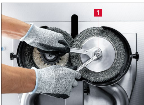
Bild 7-29 Rechte Spannmutter abschrauben
