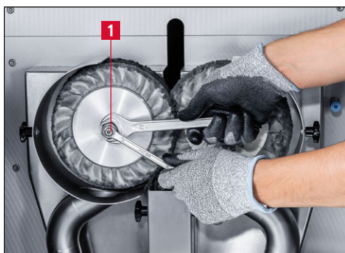
Bild 7-46 Linke Spannmutter abschrauben
