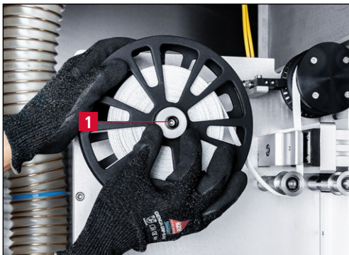
Bild 7-63 Gebrauchtes Testmedium entnehmen
