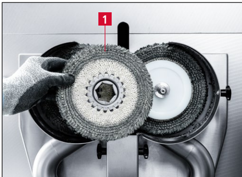
Bild 7-30 Gebrauchten Entgratring abnehmen
