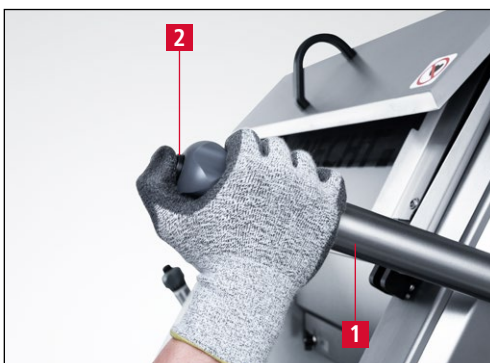
Bild 7-39 Schleifaggregat nach oben bewegen
