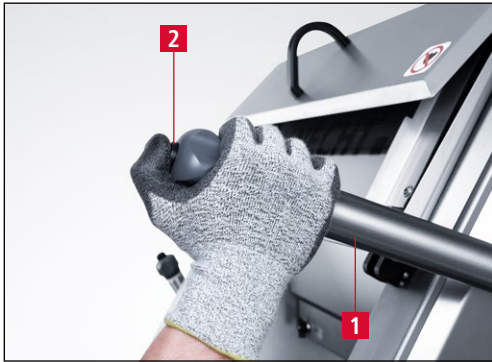
Bild 7-26 Schleifaggregat nach oben bewegen
