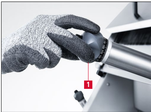
Bild 7-10 Feinzu- stellung „Schleifaggregat“
