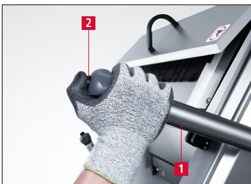
Bild 7-12 Schleifaggregat nach oben bewegen
