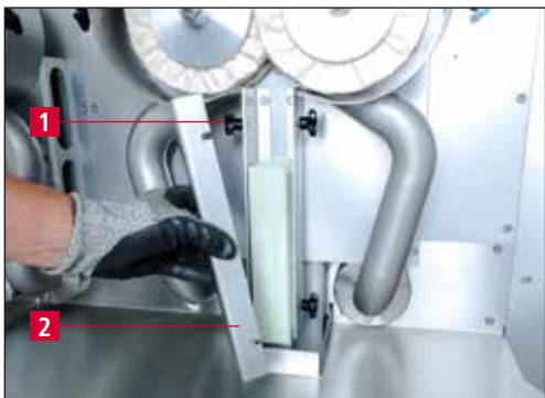
Billede 7-16 Udskiftning af poleringspasta
