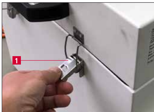
Billede 9-4 Lukkespænde på udsugningsanlægget
