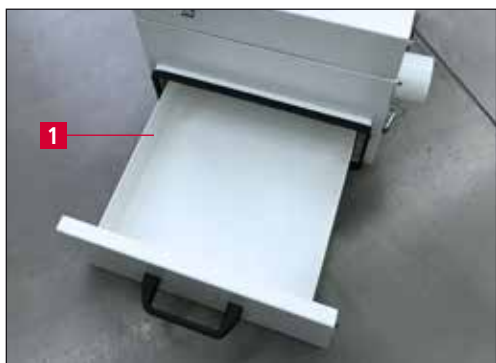
Billede 9-3 Skuffe i udsugningsanlægget
