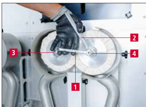
Billede 7-15 Udskiftning af polerings-/afgratningsringe
