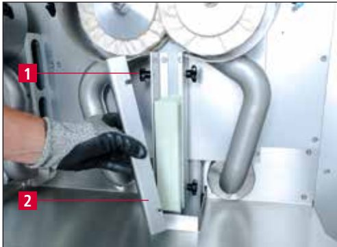
Billede 7-16 Indstilling af polerings-/afgratningsbørster
