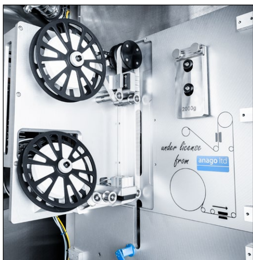
Imagen 7-21 Abrir el dispositivo de comprobación del afilado
