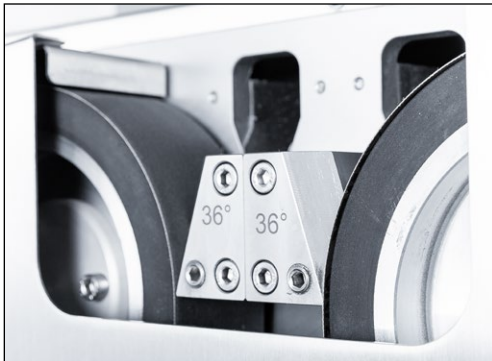
Imagen 7-9 Ajustar la cinta abrasiva en húmedo
