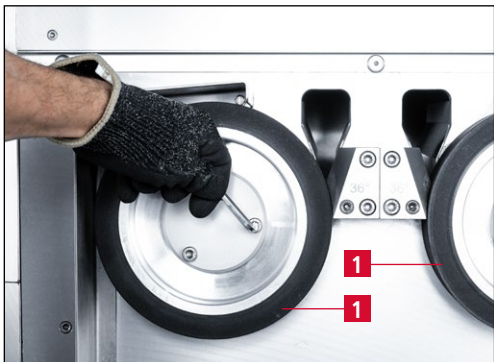
Imagen 9-1 Desmontar los discos de contacto
