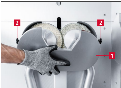
Imagen 7-17 Retirar la cubierta de protección
