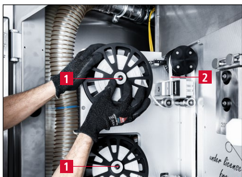
Imagen 7-22 Retirar el medio de prueba
