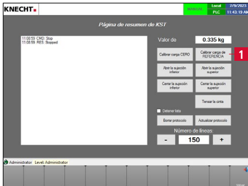
Imagen 7-29 Calibrar "Carga de REFERENCIA"
