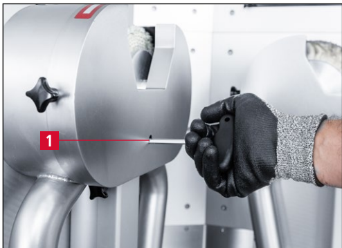
Imagen 7-20 Ajustar los anillos de pulido/desbarbado
