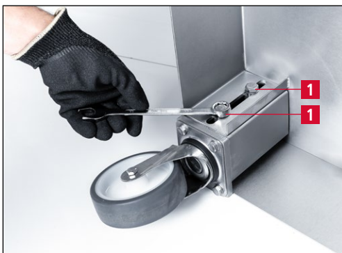
Imagen 5-2 Ajustar las ruedas giratorias
