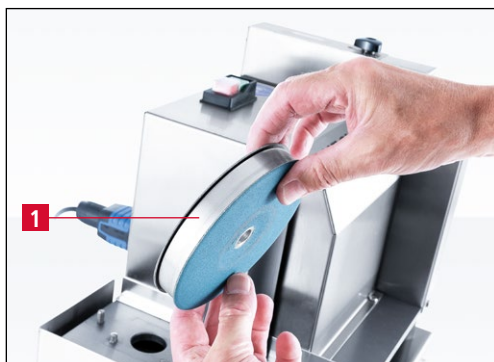
Kuva 7-11 Uuden hiomalaikkaparin asentaminen
