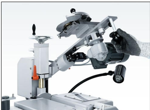
Figure 7-77 Amener le dispositif d'affûtage pour couteaux circulaires en position de serrage
