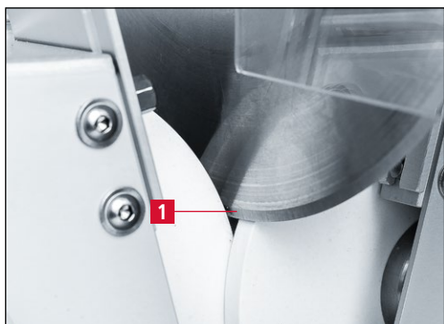
Figure 7-27 Couteaux éloignés des disques d'affûtage
