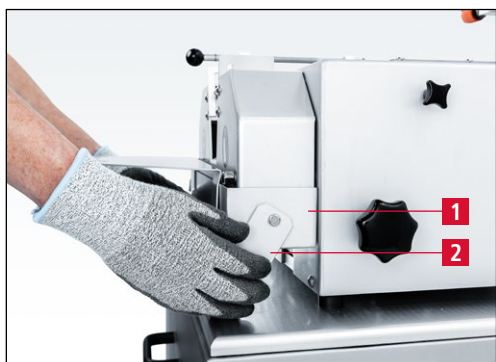
Figure 7-38 Escamotage de la coupelle d'eau
