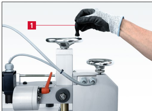
Figure 7-66 Approcher les couteaux circulaires des disques d'affûtage
