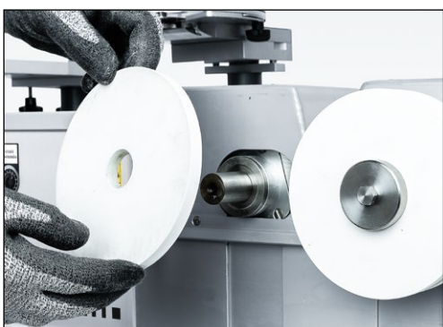
Figure 7-98 Dépose et remplacement par des disques d'affûtage neufs
