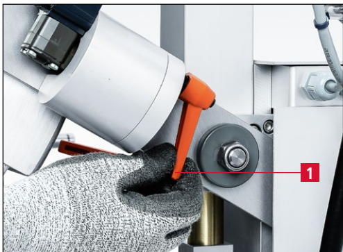
Figure 7-20 Desserrer le levier de serrage du «bras de réception» (7-20/1).
