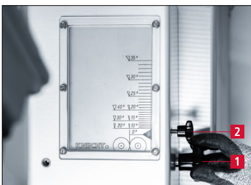
Figure 7-45 Blocage de la flèche indicatrice
