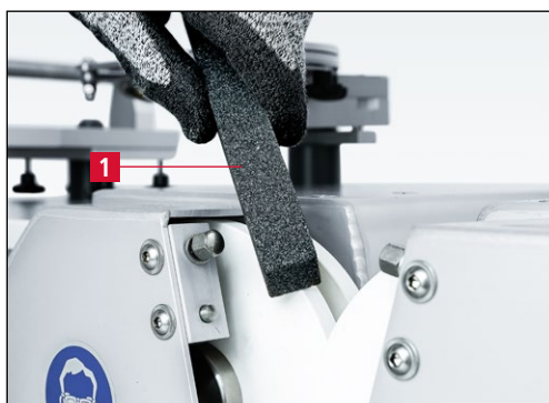
Figure 7-89 Arrondissement des arêtes des disques d'affûtage
