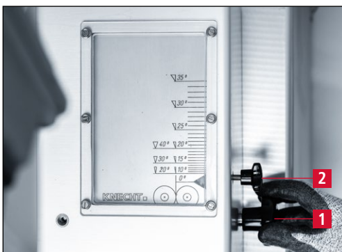
Figure 7-2 Blocage de la flèche indicatrice
