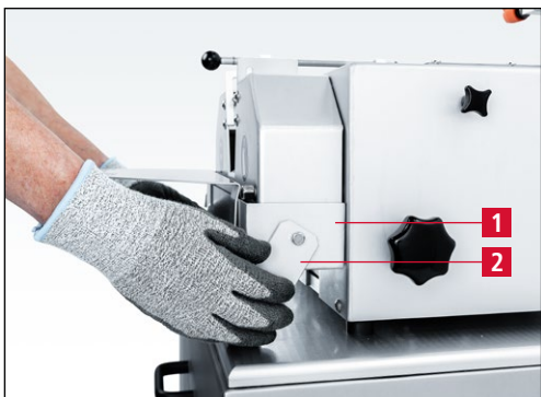
Figure 7-79 Escamotage de la coupelle d'eau
