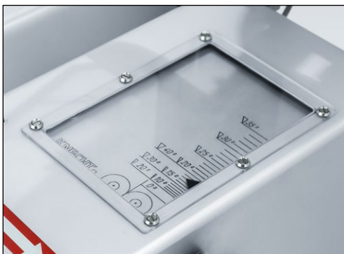
Figure 7-5 Échelle graduée d'angle
