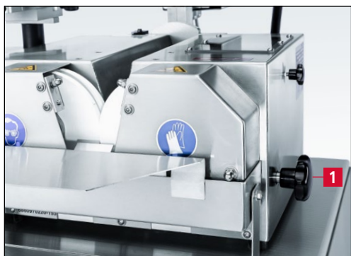
Figure 7-94 Position de remplacement des disques d'affûtage
