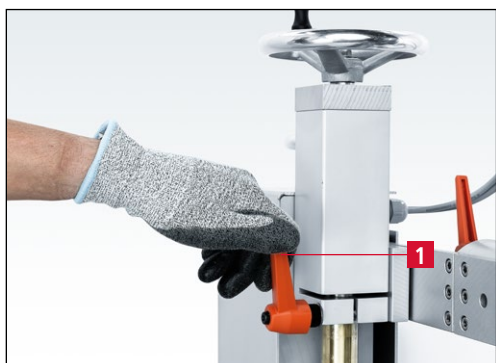
Figure 7-65 Desserrage du levier de serrage «réglage de la hauteur»
