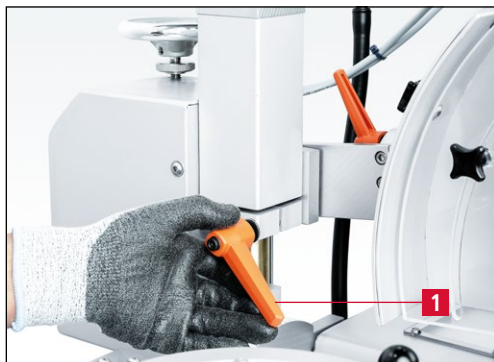
Figure 7-24 Desserrage du levier de blocage «réglage de la hauteur»
