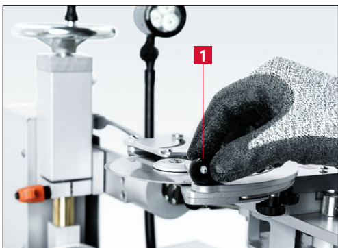
Figure 7-78 Ouverture de la vitre de protection
