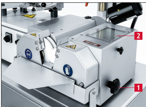
Figure 7-1 Affichage de l'angle d'affûtage
