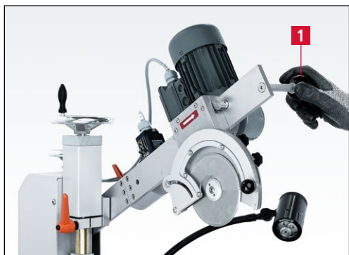
Figure 7-74 Rabattement du dispositif d'affûtage en position de repos
