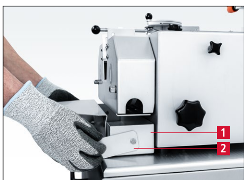
Figure 7-91 Dépose de la coupelle d'eau
