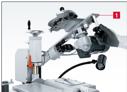
Figure 7-60 Basculement du dispositif d'affûtage pour couteaux circulaires vers le haut
