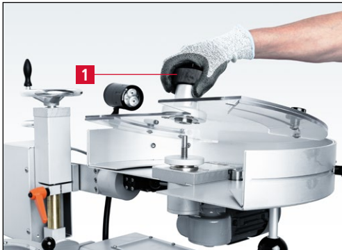
Figure 7-12 Retrait de l'écrou de serrage avec la vitre de protection
