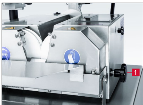
Figure 7-84 Remplacement des disques d'affûtage
