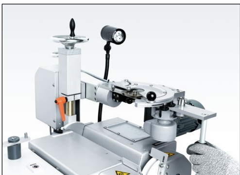
Figure 7-54 Dispositif d'affûtage pour couteaux circulaires en position de serrage
