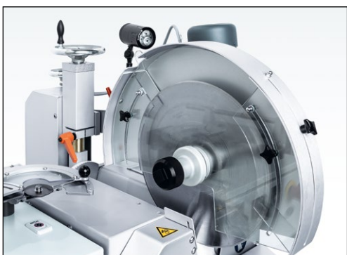
Figure 7-22 Pivotement du dispositif d'affûtage pour couteaux circulaires en position d'affûtage
