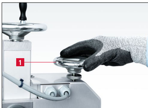
Figure 7-30 Rotation du volant à main «positionnement de précision» dans le sens antihoraire
