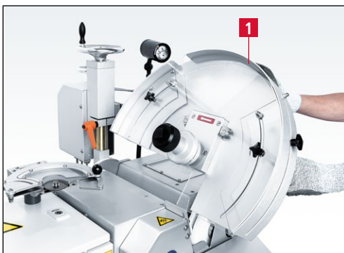
Figure 7-10 Pivotement du dispositif d'affûtage pour couteaux circulaires dans le sens horaire
