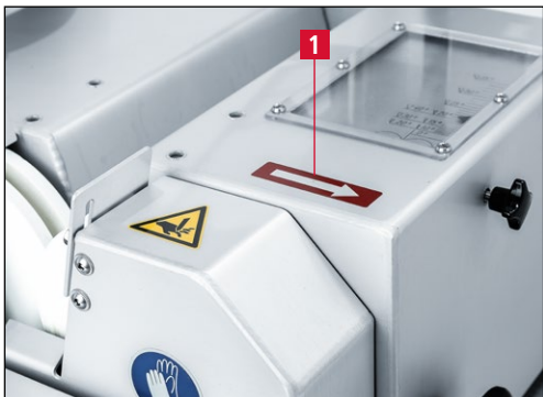
Figure 6-3 Contrôle du sens de rotation
