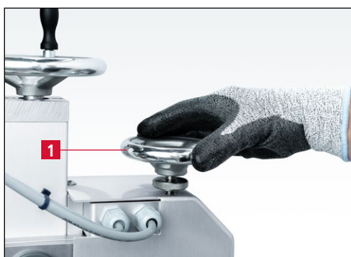
Figure 7-71 Rotation du volant à main «positionnement de précision» dans le sens antihoraire
