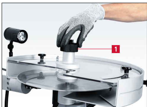
Figure 7-37 Desserrage du couteau circulaire
