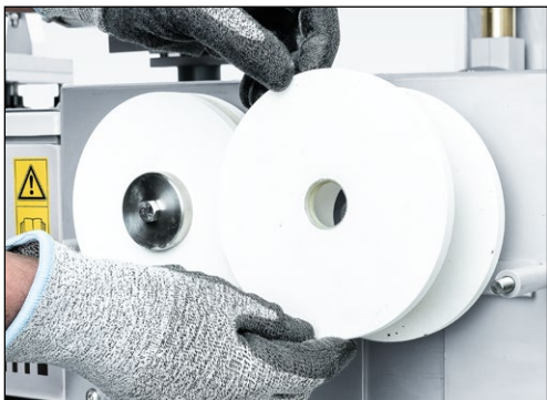
Figure 7-96 Dépose et remplacement par des disques d'affûtage neufs
