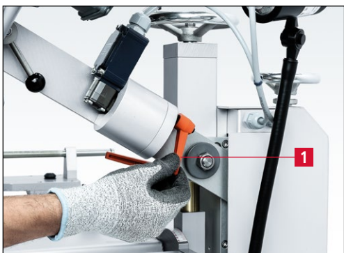
Figure 7-52 Desserrer le levier de serrage du «bras de réception»
