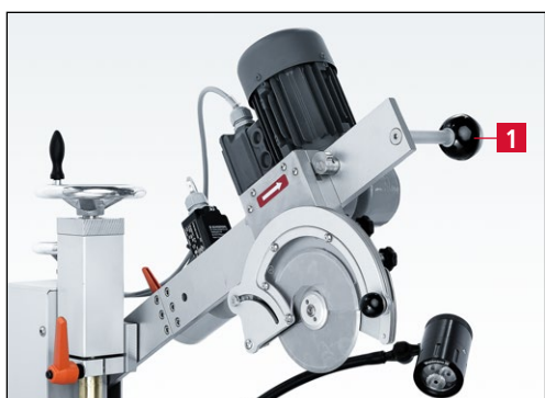
Figure 7-62 Pivotement du dispositif d'affûtage pour couteaux circulaires en position d'affûtage
