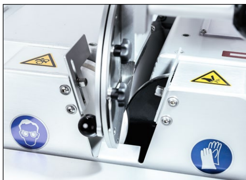
Figure 7-81 Utilisation d'un disque en acier trempé
