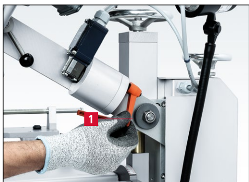
Figure 7-76 Desserrer le levier de serrage du «bras de réception»
