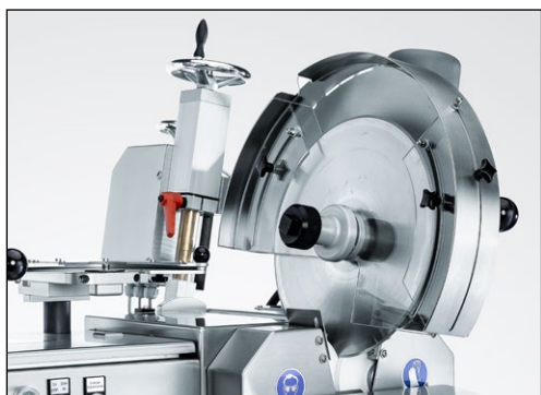
Figure 7-41 Inclinaison du dispositif d'affûtage
