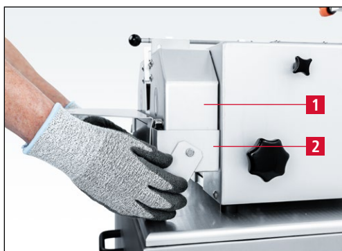
Figure 7-100 Montage du capot de protection et de la coupelle d'eau
