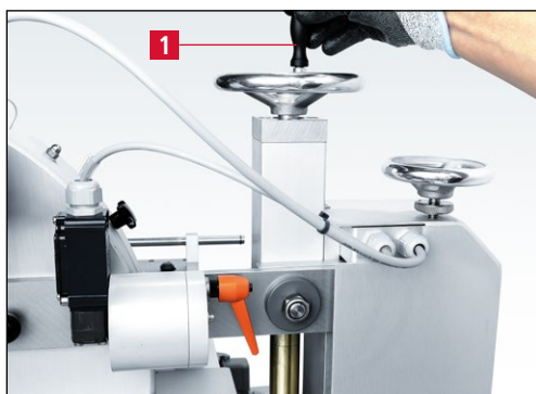
Figure 7-25 Approcher les couteaux circulaires des disques d'affûtage
