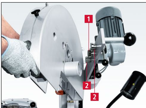
Figure 7-7 Montage du support pour couteaux circulaires
