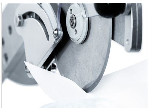
Figure 7-75 Contrôle de l'affûtage du couteau
