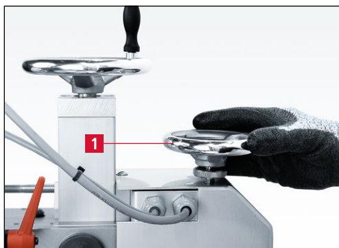
Figure 7-67 Rotation du volant à main «positionnement de précision» dans le sens horaire
