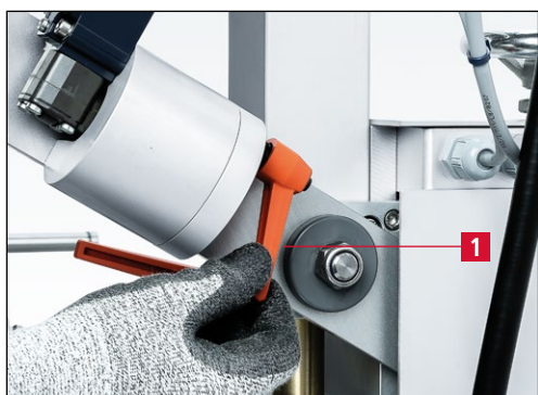
Figure 7-61 Desserrer le levier de serrage du «bras de réception»
