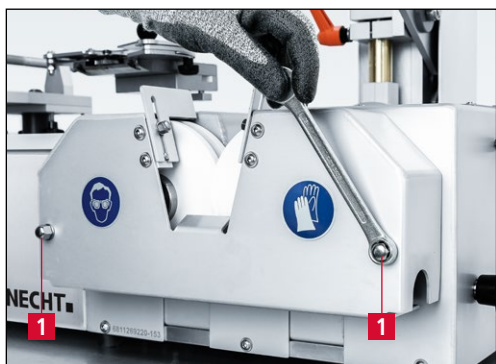
Figure 7-92 Dévissage des écrous borgnes
