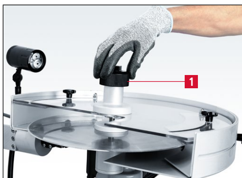
Figure 7-18 Mise en place de la vitre de protection
