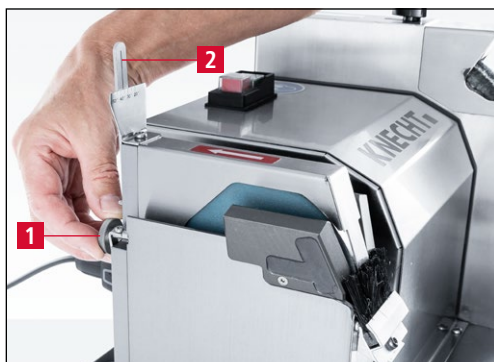
7-1. ábra A csiszolási szög beállítása
