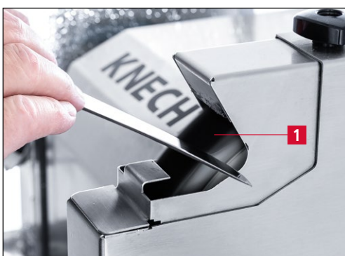
7-6. ábra A kézikés polírozása
