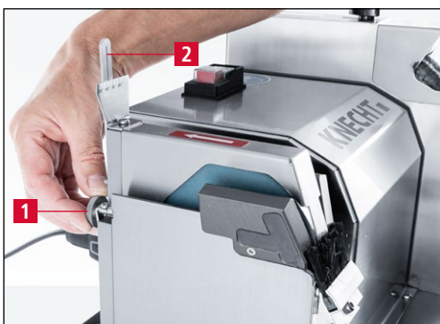
7-2. ábra A csiszolási szög beállítása
