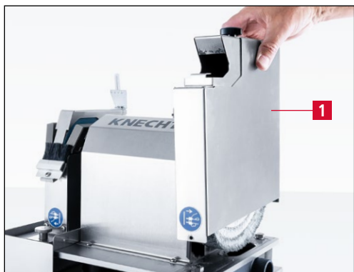
7-14. ábra A polírozótárca burkolatának levétele
