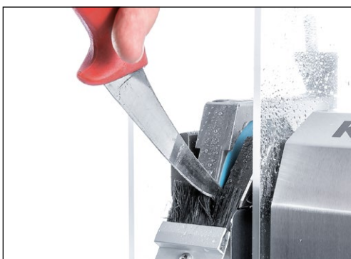
7-4. ábra A kézikés csiszolása
