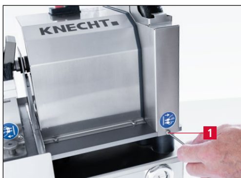
7-13. ábra A polírozótárcsa burkolatának kioldása
