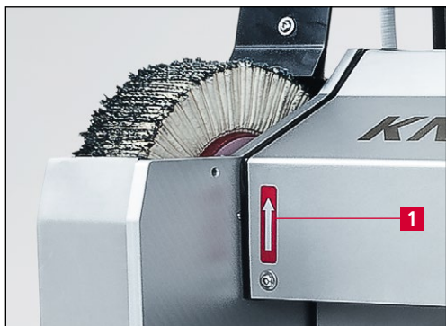
6-2. ábra A forgásirány ellenőrzése
