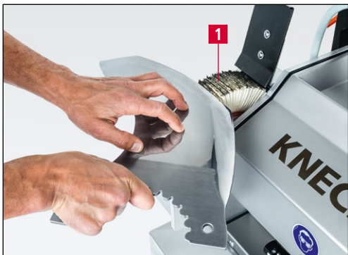
7-6. ábra A vágókés sorjázása és polírozása
