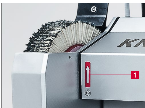
6-2. ábra A forgásirány ellenőrzése
