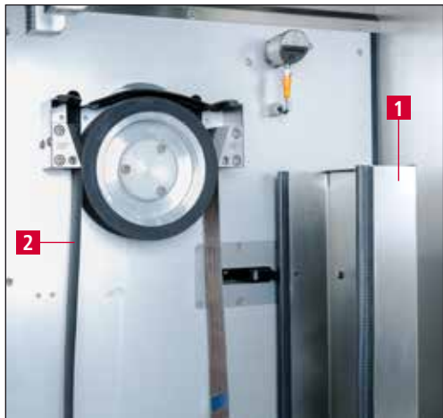
7-4 pav. Šlapio šlifavimo juostos keitimas
