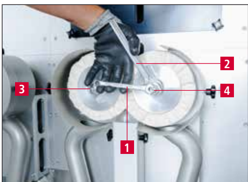
7-15 pav. Poliravimo/šerpetų šalinimo žiedų keitimas
