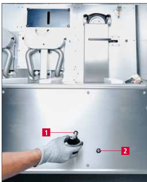
7-13 pav. Šlapio šlifavimo juostos išlygiavimas
