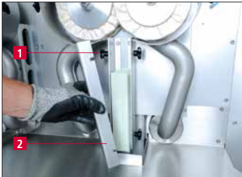
7-16 pav. Poliravimo pastos keitimas
