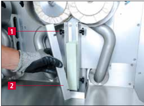
7-16 pav. Poliravimo pastos keitimas
