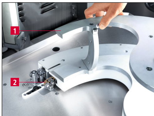
Afbeelding 7-16 Kopieerslijpplaat op geleidewagen schuiven
