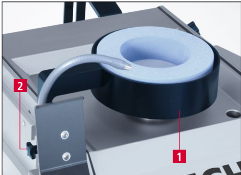
Afbeelding 7-11 Beveiliging slijpschijf instellen
