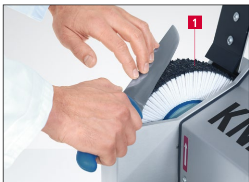
Afbeelding 7-8 Handmessen ontbramen en polijsten
