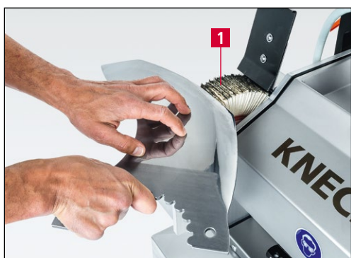
Afbeelding 7-6 Cuttermes ontbramen en polijsten
