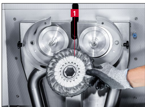
Bilde 7-50 Bytte poleringsringer
