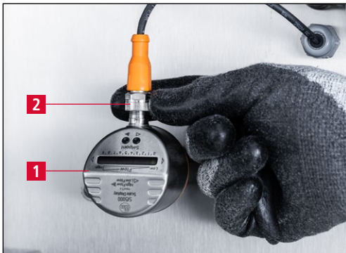
Bilde 9-6 Koble fra strømningsovervåkingen
