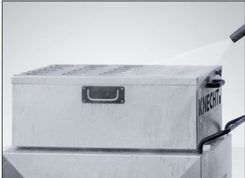
Bilde 9-9 Rengjøring knivmagasiner
