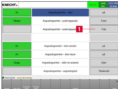
Bilde 7-35 Påføre poleringspasta
