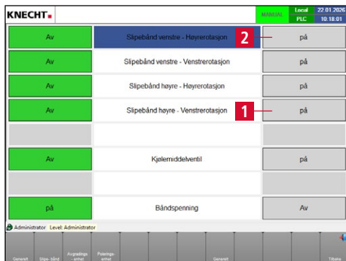
Bilde 7-19 Manuelle funksjoner «Slipbånd»
