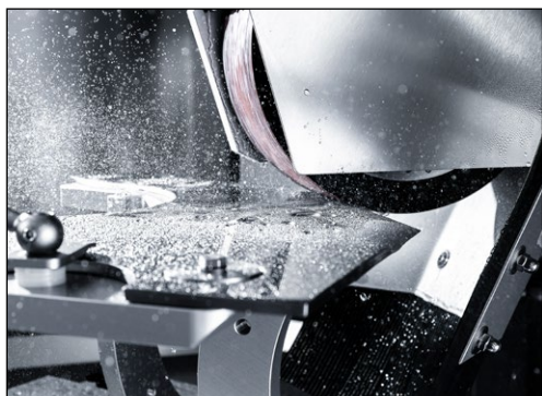
Rys. 7-53 Szlifowanie liniowego noża kutrowego
