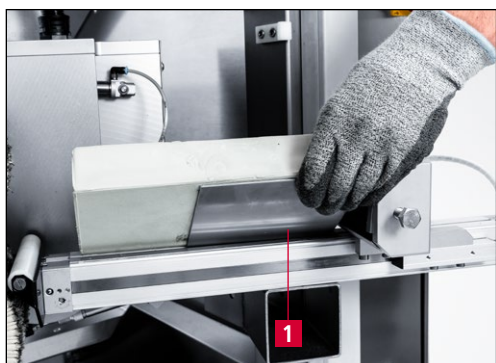
Rys. 7-81 Wymiana pasty polerskiej jednostki gratującej
