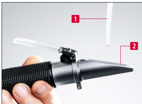
Rys. 9-22 Pomiar stężenia środka chłodząco-smarującego
