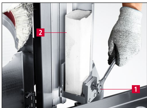
Rys. 7-79 Wymiana pasty polerskiej jednostki polerującej
