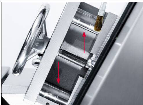
Rys. 9-12 Smarowanie prowadnic i wrzecion regulacyjnych regulacji kąta
