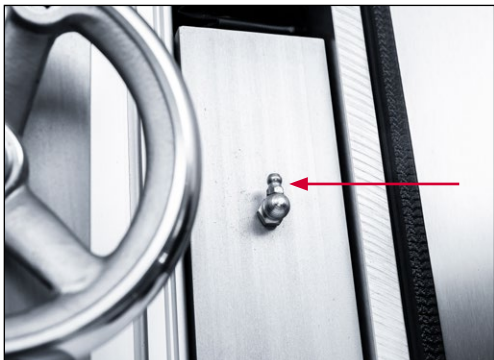
Rys. 9-10 Smarowanie przedniej obudowy prowadnicy
