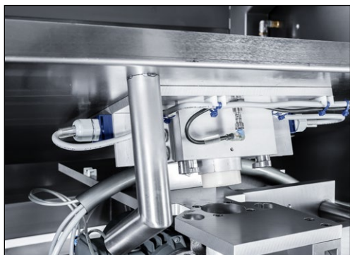
Rys. 9-7 Demontaż blachy ślizgowej
