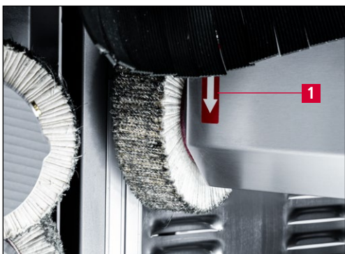
Rys. 6-5 Kontrola kierunku obrotów
