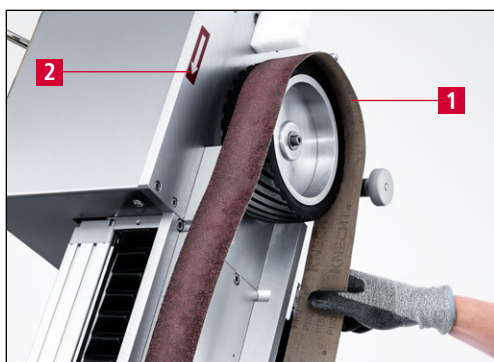
Rys. 7-61 Wymiana taśmy szlifierskiej do szlifowania na mokro
