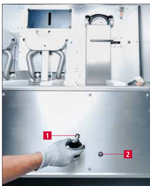
Rys. 7-13 Ustawianie taśmy szlifierskiej do ostrzenia na mokro
