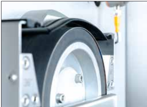
Rys. 7-8 Ustawianie taśmy szlifierskiej do ostrzenia na mokro
