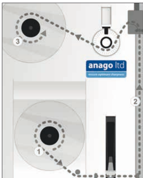
Rys. 7-21 Osadzanie nowego elementu testowego
