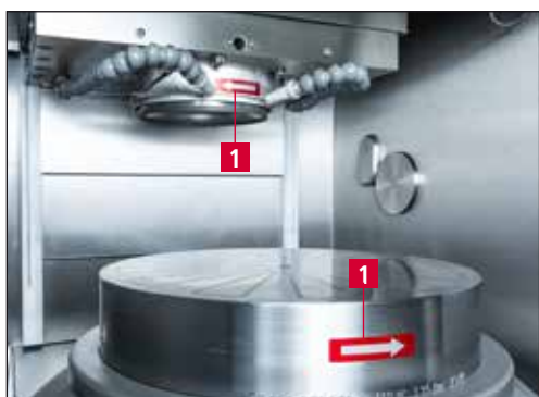
Ilustracja 6-4 Kontrola kierunku obrotu
