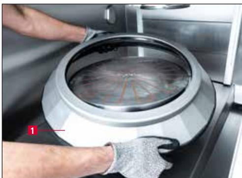
Ilustracja 9-6 Wyjmowanie pierścienia ociekowego
