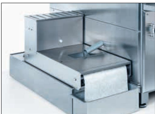
Ilustracja 3-7 Urządzenie chłodzące z filtrem taśmowym
