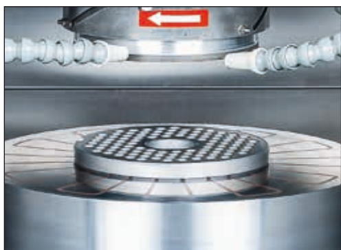
Ilustracja 7-5 Tarcza otworowa na stole okrągłym
