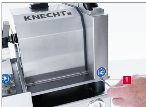
Imagem 7-13 Soltar a cobertura do disco de polimento
