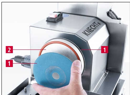
Imagem 7-10 Remover os discos de afiação usados
