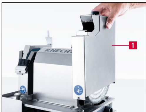
Imagem 7-14 Retirar a cobertura do disco de polimento
