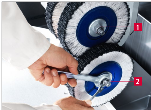
Figura 7-22 Schimbarea periilor lamelare ale unității de debavurare
