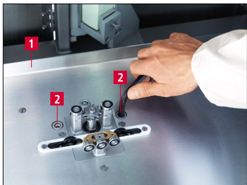
Figura 9-7 Demontarea tablei de protecție
