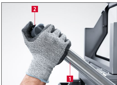
Рис. 7-20 Рычаг подачи шлифовального узла
