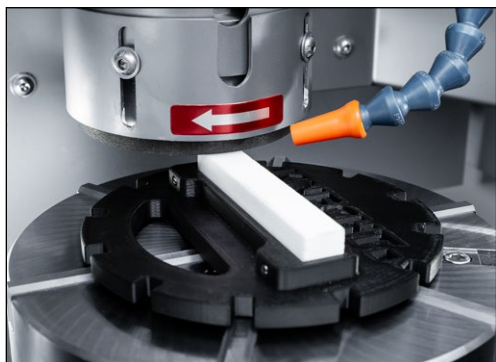
Рис. 7-40 Шлифовальный узел в рабочем положении
