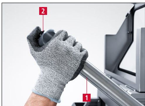
Рис. 7-12 Рычаг подачи шлифовального узла
