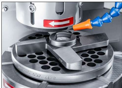
Рис. 7-24 Шлифовальный узел в рабочем положении
