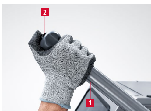
Рис. 7-16 Перемещение шлифовального узла вверх
