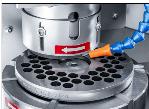
Рис. 7-7 Шлифовальный узел в рабочем положении
