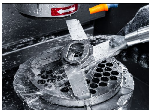
Рис. 7-34 Промывка крестовидного ножа
