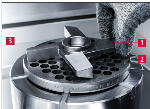
Рис. 7-23 Крестовидный нож на круглом столе
