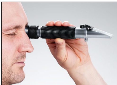
Рис. 8-9 Считывание показателя преломления
