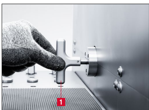
Рис. 7-11 Закрытие фиксирующей ручки
