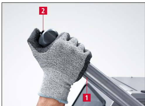
Рис. 7-33 Перемещение шлифовального узла вверх
