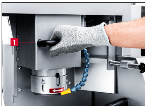
Рис. 7-9 Приведение шлифовального узла в рабочее положение
