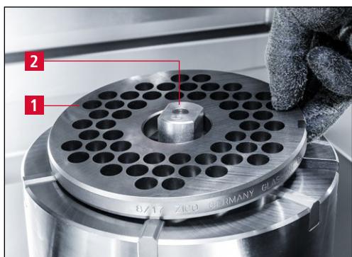
Рис. 7-22 Укладка решетки мясорубки на круглый стол
