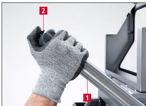
Рис. 7-44 Рычаг подачи шлифовального узла
