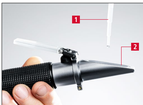
Рис. 8-8 Измерение концентрации СОЖ
