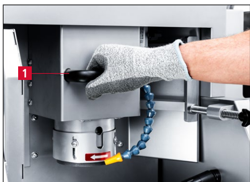
Рис. 7-42 Приведение шлифовального узла в рабочее положение
