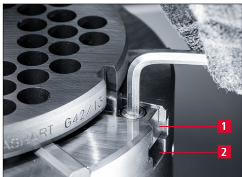
Рис. 7-6 Фиксация решетки мясорубки
