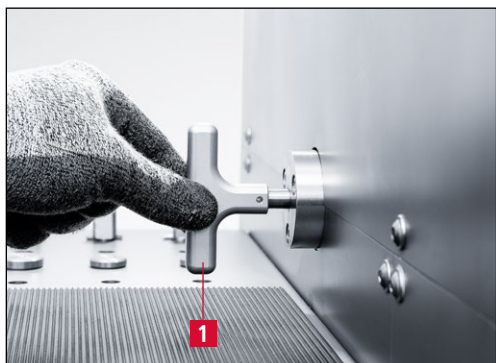
Рис. 7-43 Закрытие фиксирующей ручки
