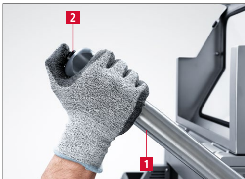
Рис. 7-3 Рычаг подачи шлифовального узла
