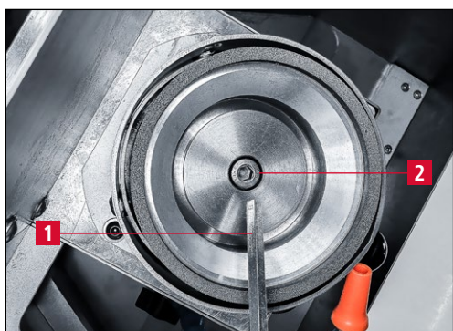
Рис. 7-48 Освобождение шлифовального круга
