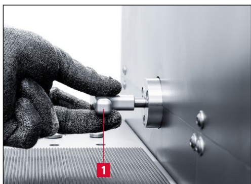
Рис. 7-25 Открывание фиксирующей рукоятки
