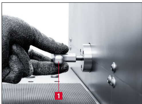
Рис. 7-18 Открывание фиксирующей рукоятки
