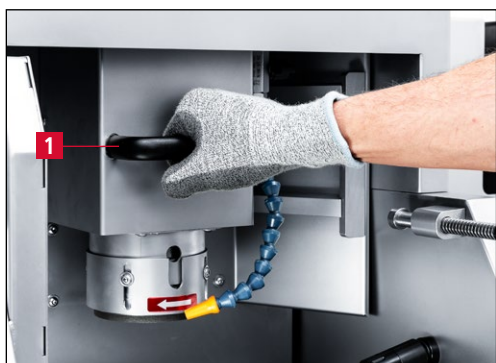
Рис. 7-19 Поворот шлифовального узла назад
