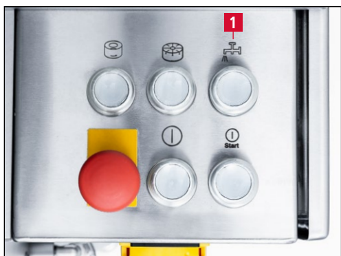
Рис. 7-35 Подача охлаждающей жидкости вкл. / выкл.
