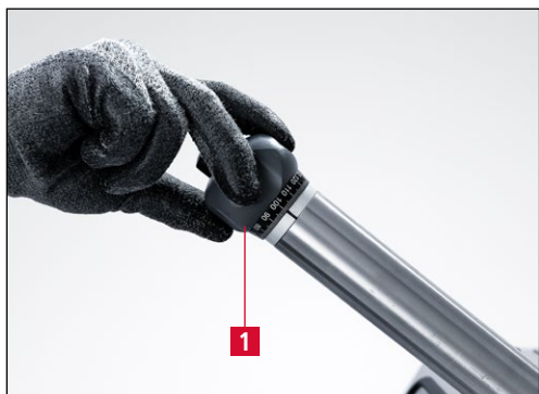
Рис. 7-14 Микроподача шлифовального узла
