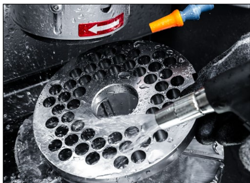
Рис. 7-17 Промывка решетки мясорубки и круглого стола
