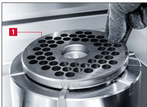
Рис. 7-5 Укладка решетки мясорубки на круглый стол
