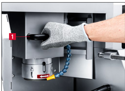
Рис. 7-2 Перемещение шлифовального узла назад
