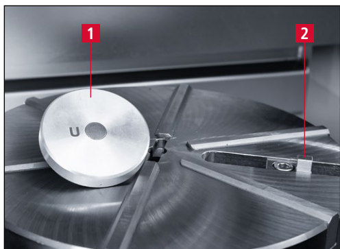
Рис. 3-4 Центрирующий элемент и поводок
