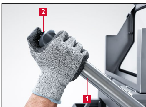
Рис. 7-29 Рычаг подачи шлифовального узла
