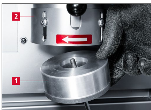
Рис. 7-49 Замена шлифовального круга
