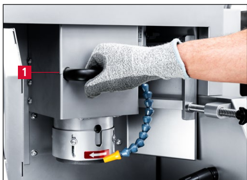
Рис. 7-26 Приведение шлифовального узла в рабочее положение
