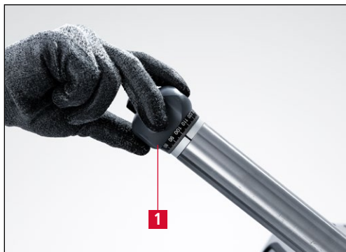
Рис. 7-31 Микроподача шлифовального узла
