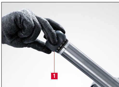
Рис. 7-13 Микроподача шлифовального узла
