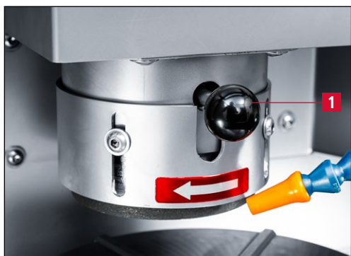
Рис. 7-47 Фиксация шлифовального круга
