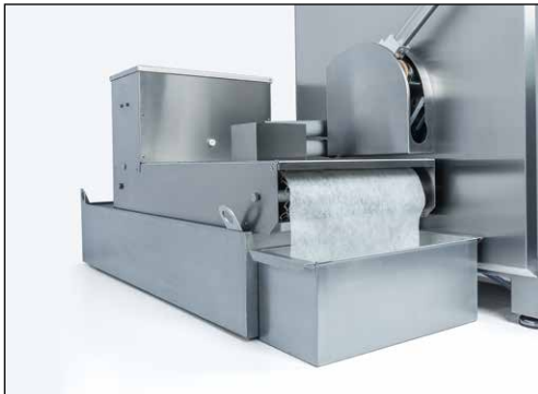
Bild 3-6 Köldmedelssystem med bandfilter
