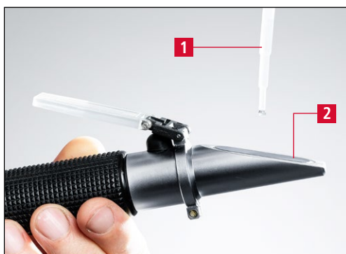
Figure 8-11 Mesurer la concentration de lubrifiant de refroidissement
