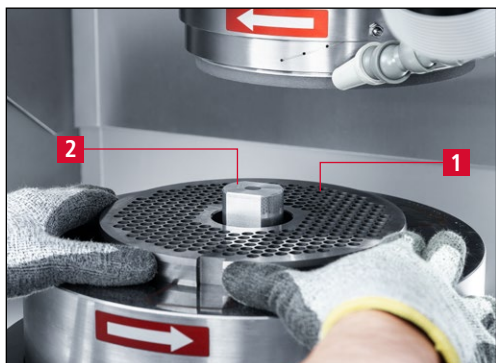
Figure 7-16 Placer la grille pour hachoir sur la table circulaire
