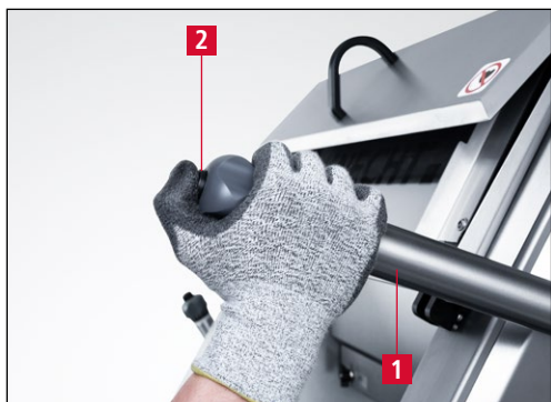
Figure 7-36 Levier de commande «Groupe d'affûtage»
