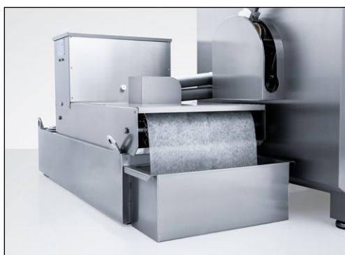
Figure 6-1 Remplir le dispositif de refroidissement à bande filtrante
