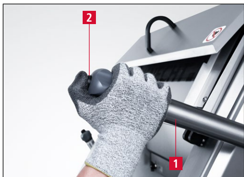
Figure 7-22 Levier de commande «Groupe d'affûtage»
