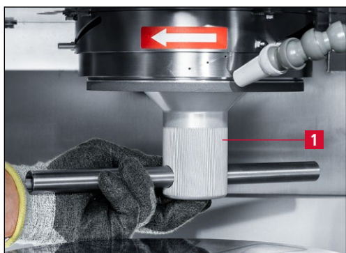
Figure 7-42 Remplacer le disque d'affûtage
