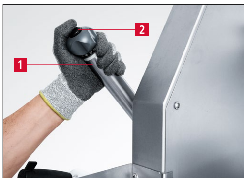
Figure 7-35 Levier de commande «Table circulaire»
