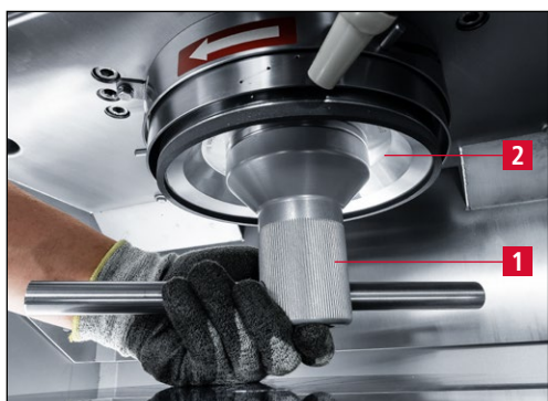
Figure 7-41 Desserrer le disque d'affûtage
