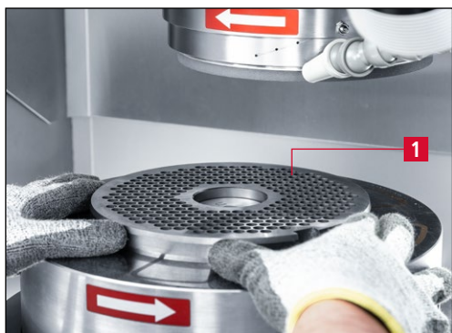
Figure 7-3 Placer la grille pour hachoir sur la table circulaire
