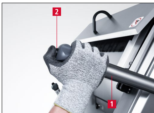
Bild 7-39 Schleifeinheit nach oben bewegen
