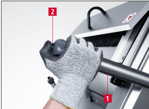
Bild 7-26 Schleifeinheit nach oben bewegen
