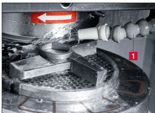
Imagen 6-5 Manguera de refrigerante
