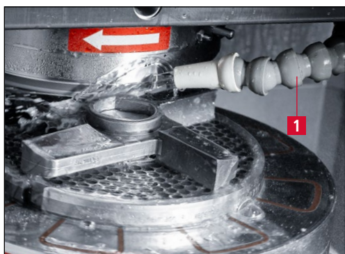
Imagen 7-31 Manguera de refrigerante
