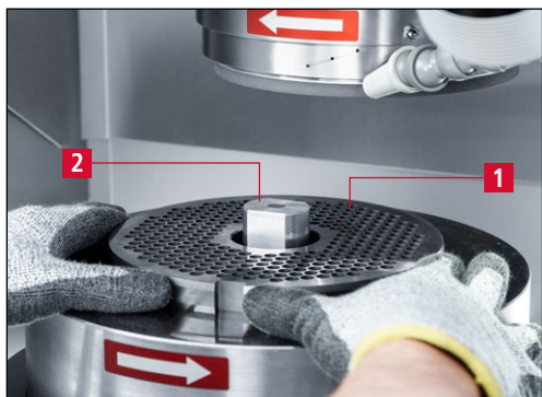
7-16. ábra Darálótárcsa körasztalra helyezése
