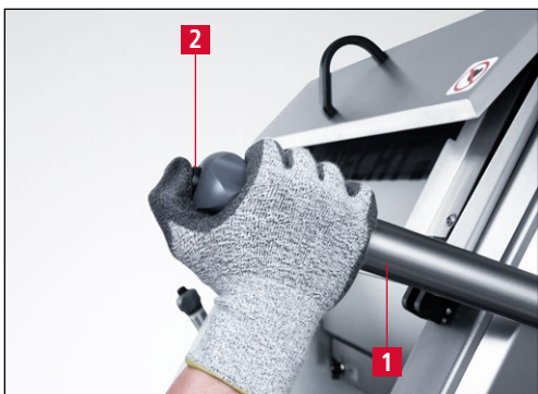
7-36. ábra „Köszörűegység” beállítókar
