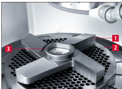
7-17. ábra A keresztlés felhelyezése a körasztalra
