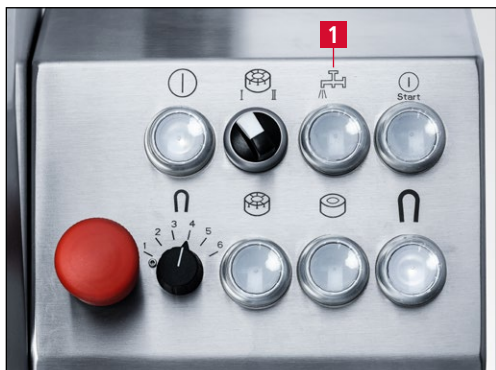
7-29. ábra A hűtőanyag-ellátás be-/kikapcsolása
