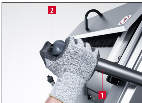
7-22. ábra „Köszörűegység” beállítókár
