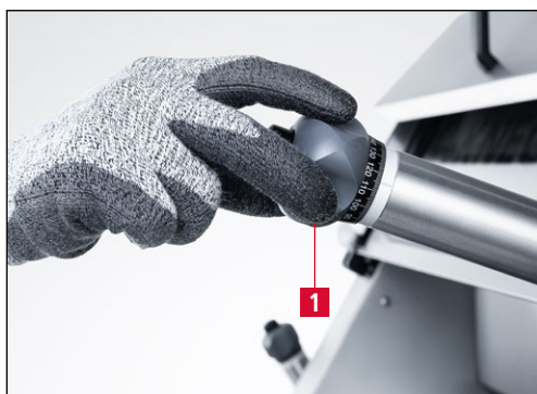
7-38. ábra „Köszörűberendezés” finombeállítás
