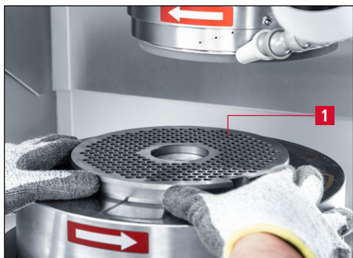
7-3. ábra Darálótárcsa elhelyezése a körsztalon
