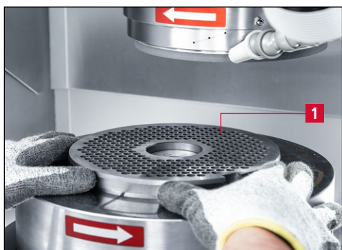
Rys. 7-3 Kładzenie sitka do wilka na stole okrągłym
