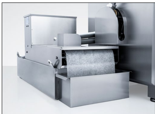
Rys. 6-1 Napełnianie systemu chłodzenia cieczą filtra taśmowego
