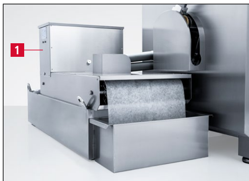
Rys. 3-8 System chłodzenia cieczą filtra taśmowego
