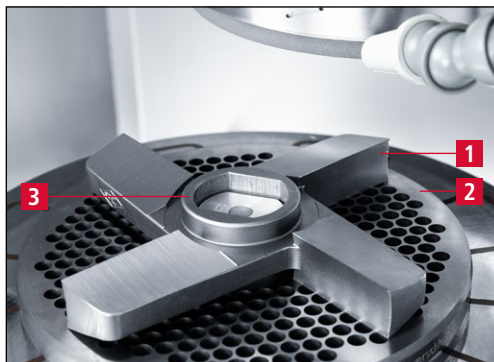
Bild 7-17 Stjärnkniv på rundbordet
