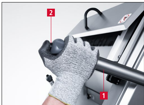
Bild 7-26 Flytta slipenheten uppåt
