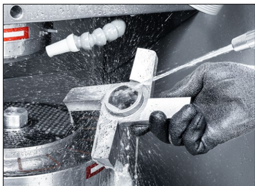
Bild 7-27 Skölja av stjärnkniv
