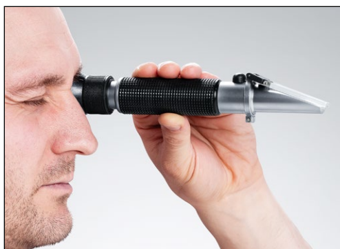
Bild 8-12 Läsa av brytningsindex
