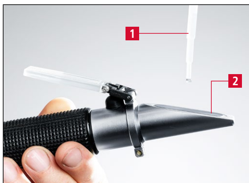
Bild 8-11 Mäta koncentrationen av kylsmörjmedel
