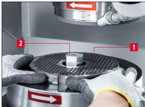
Bild 7-16 Placera hålskiva på rundbordet
