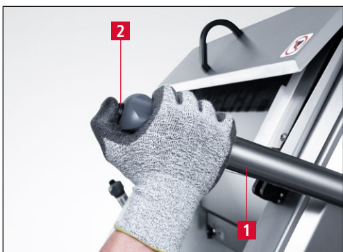
Bild 7-12 Flytta slipenheten uppåt
