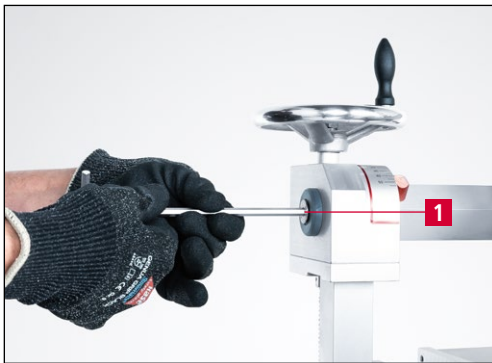
Obrázek 6-1 Demontáž otočného ramene
