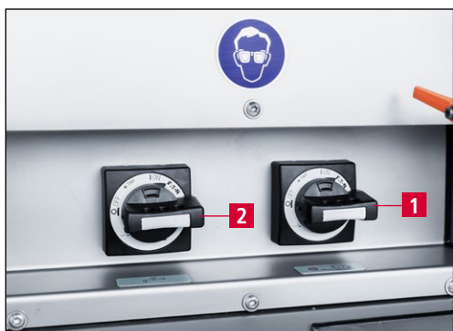
Obrázek 7-10 Zapnutí brusky a chladicí jednotky
