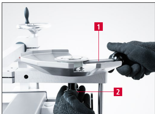
Obrázek 7-4 Upevnění kruhového nože
