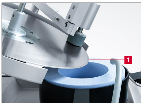
Obrázek 7-18 Umístění kruhového nože na brusný kotouč
