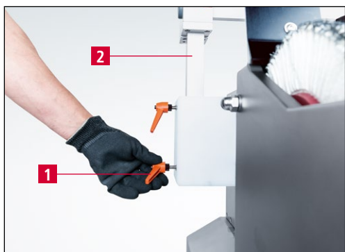
Obrázek 7-6 Seřízení zařízení na broušení kruhových nožů
