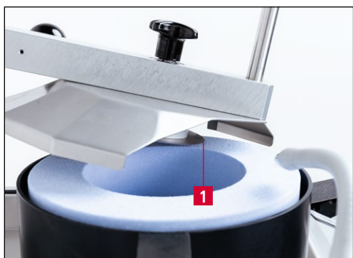
Obrázek 7-5 Umístění kruhového nože na brusný kotouč
