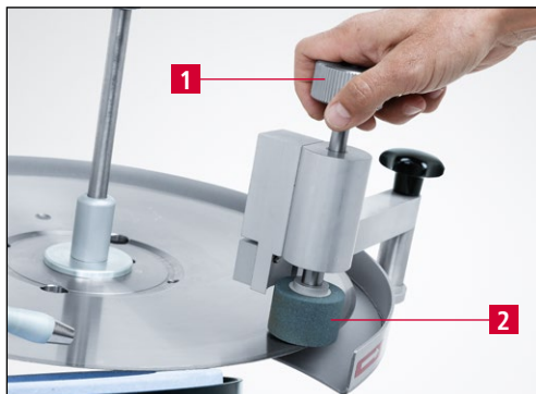
Obrázek 7-24 Odstranění otřepů z kruhových nožů
