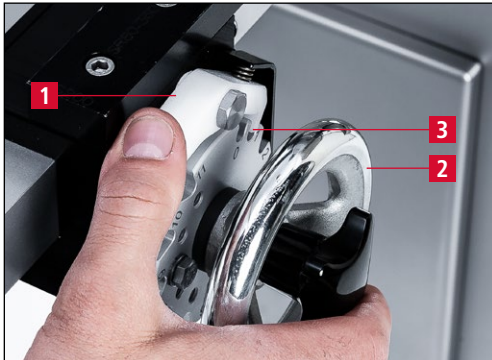
Bild 7-16 Schlefeinrichtung in Schleifposition „1“ bringen
