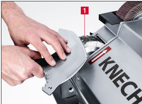
Bild 7-22 Kuttermesser auf der Polierscheibe entgraten und polieren
