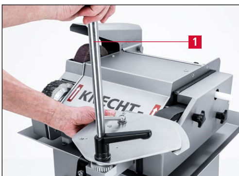
Bild 7-21 Kuttermesser auf nächstes Schneidensegment schwenken
