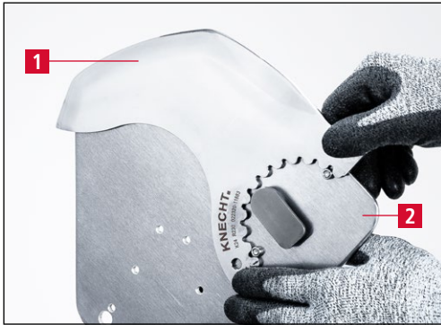
Bild 7-8 Messer auf Schleifplatte aufspannen
