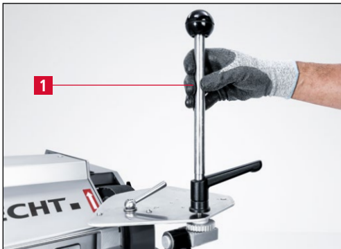
Bild 7-4 Schleifhebel leicht festziehen
