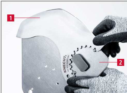
Bild 7-8 Messer auf Schleifplatte aufspannen
