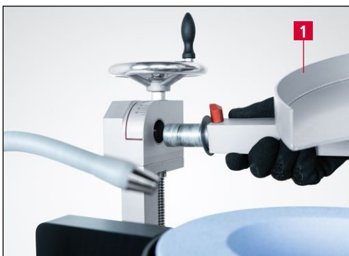
Bild 6-2 Kreismesserschleifeinrichtung HV 205-1 | HV 205-2 montieren
