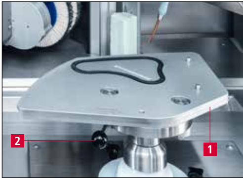
Imagen 7-6 Fijar el alojamiento de cuchillas
