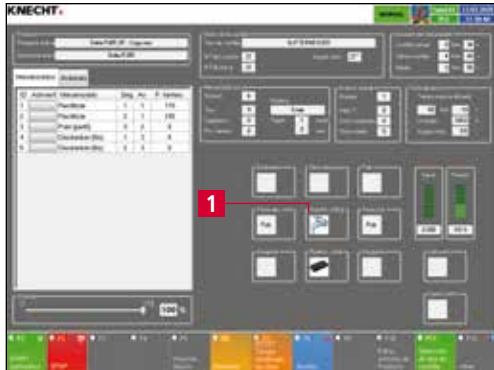
Imagen 9-3 Prender/Apagar la bomba refrigerante
