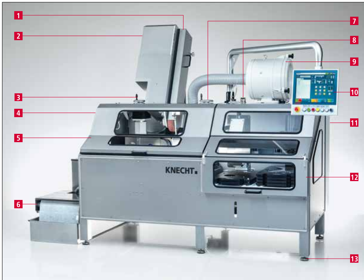
Imagen 3-2 Vista de conjunto de la rectificadora
