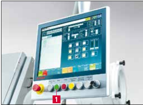
Imagen 7-9 Iniciar el proceso de rectificado
