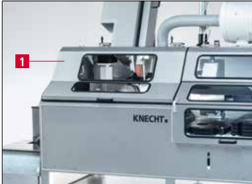
Imagen 3-11 Cubierta de protección del espacio de rectificación
