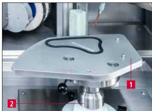
Imagen 7-5 Colocar el alojamiento de cuchillas SP 114
