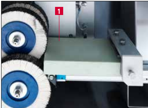
Imagen 7-19 Insertar la nueva pasta de pulido
