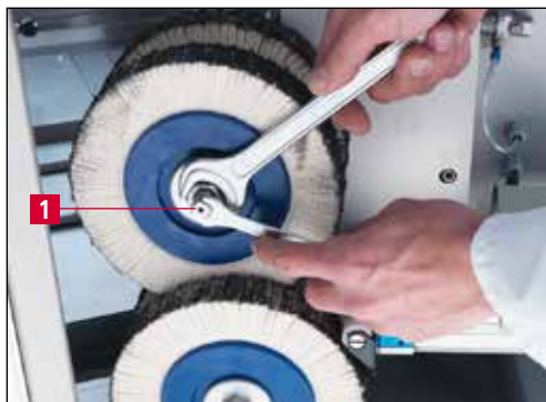
Imagen 7-17 Sustituir el cepillo de láminas de la unidad de desbarbado
