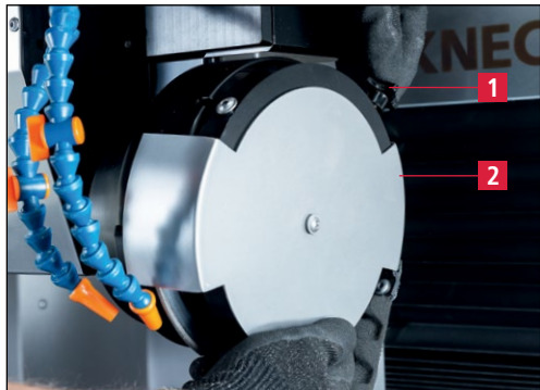
Figure 7-76 Démontage du capot de protection
