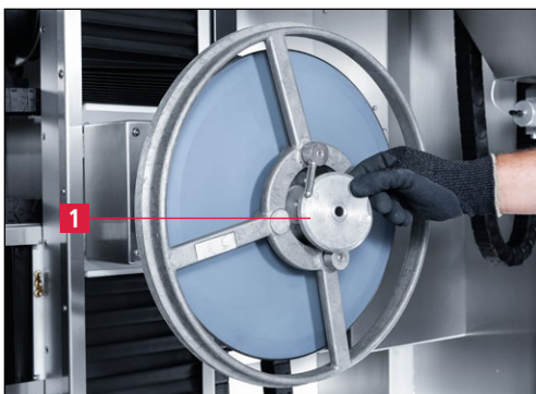
Figure 7-47 Mise en place de la bride de serrage
