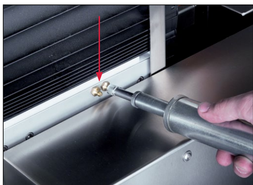
Figure 9-8 Graissage du chariot croisé en haut
