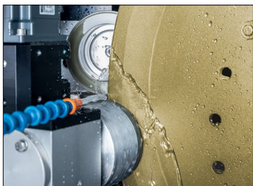
Figure 7-16 Affûtage et ébavurage du couteau falciforme
