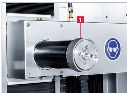
Figure 7-59 Écrou de serrage
