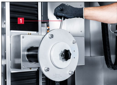
Figure 7-7 Serrage de l'écrou de serrage
