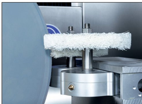
Figure 7-70 Polissage des couteaux circulaires
