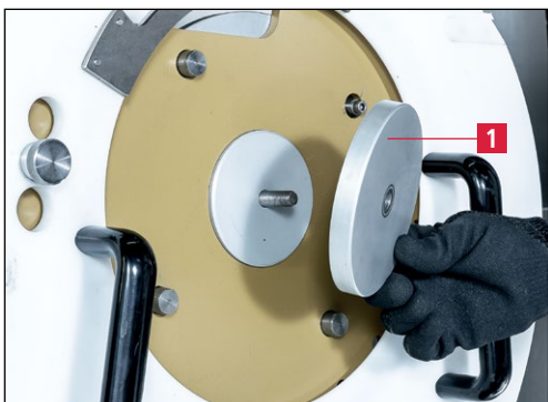
Figure 7-30 Mise en place de la bride de serrage
