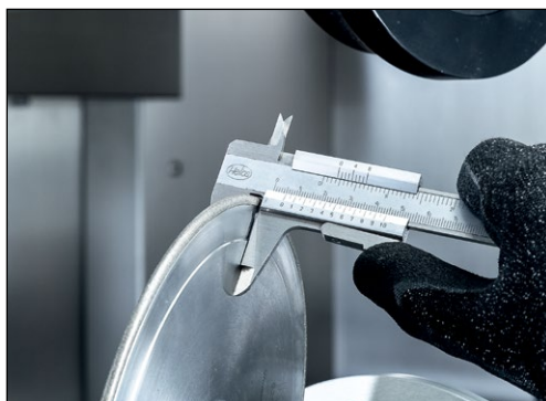
Figure 7-56 Mesure de l'épaisseur du disque d'entrée de denture
