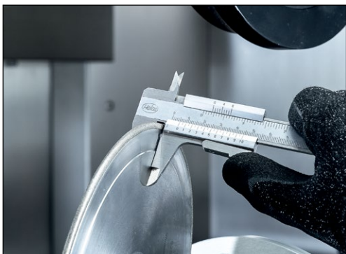
Figure 7-21 Mesure de l'épaisseur du disque d'entrée de denture
