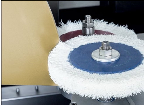
Figure 7-71 Positionnement de l'unité de polissage
