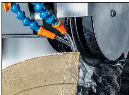
Figure 7-35 Affûtage de la denture du couteau falciforme
