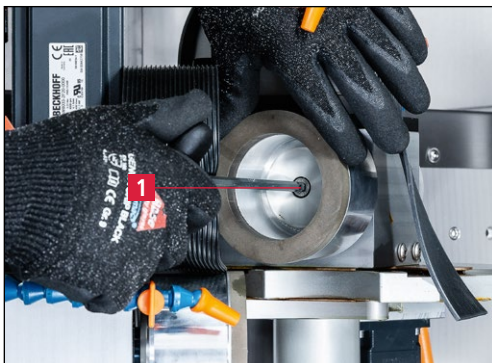
Figure 7-74 Remplacement des disques d'affûtage
