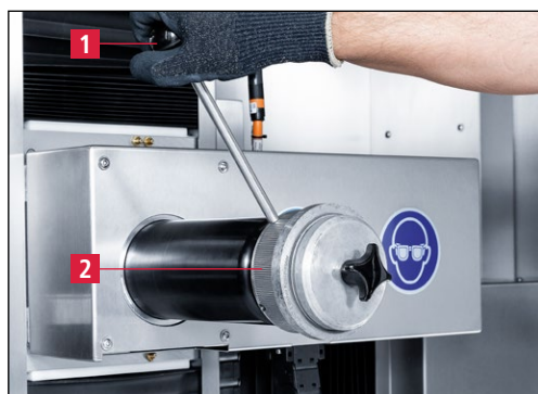
Figure 7-43 Serrage de l'écrou de serrage
