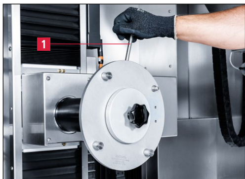
Figure 7-26 Serrage de l'écrou de serrage
