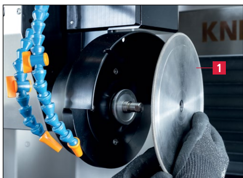
Figure 7-78 Remplacement du disque d'entrée de denture
