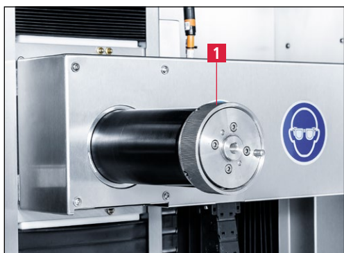
Figure 7-5 Écrou de serrage
