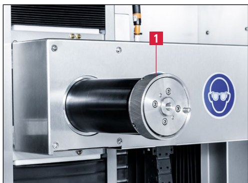
Figure 7-24 Écrou de serrage
