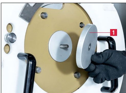
Figure 7-11 Mise en place de la bride de serrage
