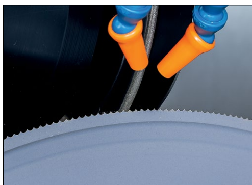
Figure 7-69 Affûtage de la denture des couteaux circulaires
