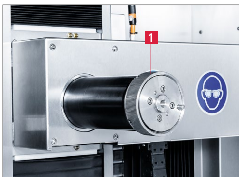
Figure 7-41 Écrou de serrage
