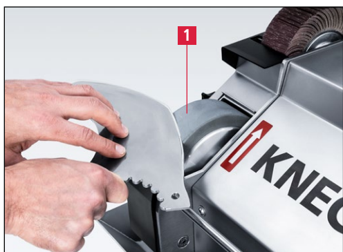
7-38. ábra A kések sorjázása nedves fenőkorongon
