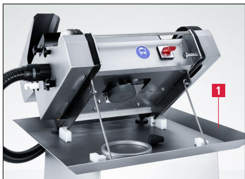
6-1. ábra A víztartály feltöltése
