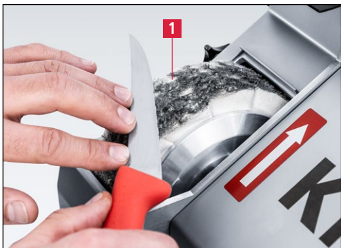
7-5. ábra Kézi kés sorjázása és polírozása
