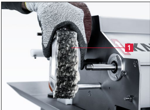
7-49. ábra Polírozókorong levétele, új korong felhelyezése
