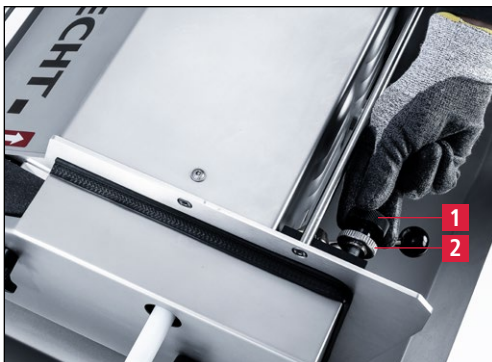
7-45. ábra A szalag haladásának szabályozása
