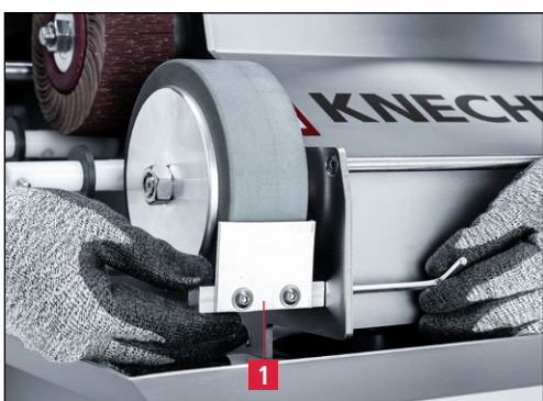
7-32. ábra A lehúzó felszerelése
