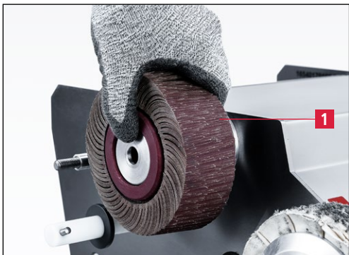
7-53. ábra Lamellás élezőkorong levétele és az új korong felhelyezése
