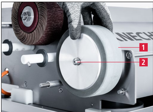
7-30. ábra Nedves fenőkorong felszerelése
