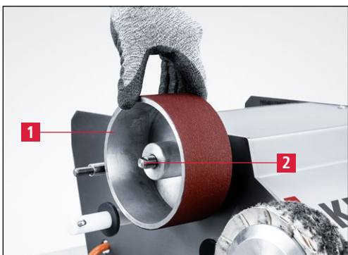
7-15. ábra A hullámos köszörűkorong felszerelése
