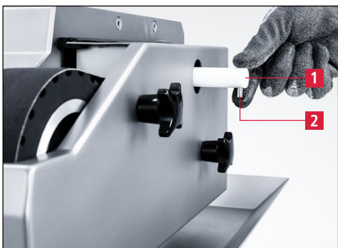
7-55. ábra A vízfúvóka beállítása
