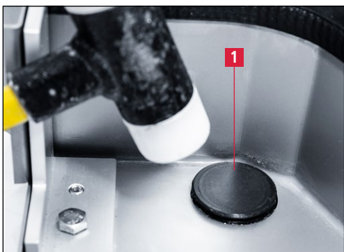
7-25. ábra Zárófedél eltávolítása
