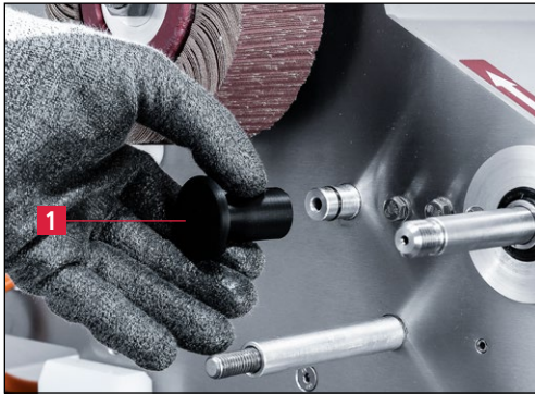
7-27. ábra Védőfedél lehúzása
