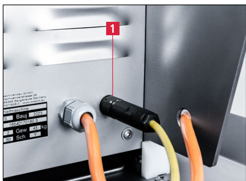
7-11. ábra Csatlakozó ipari porszívó számára
