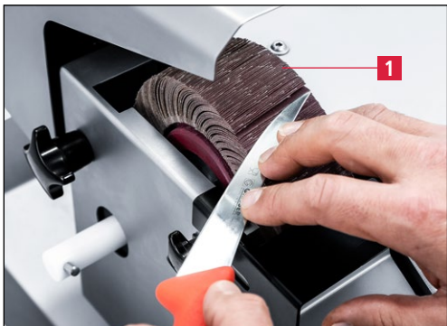
7-3. ábra Kézi kés finomköszörülése
