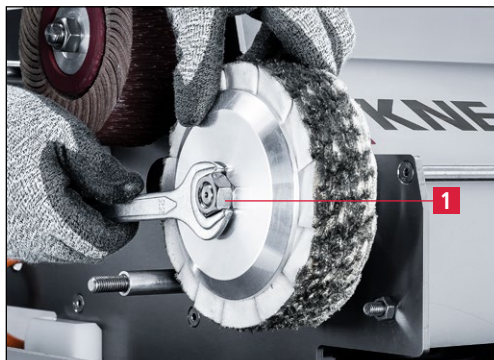
7-48. ábra Polírozókorong oldása
