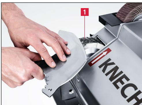
7-9. ábra Vágókés sorjázása és polírozása
