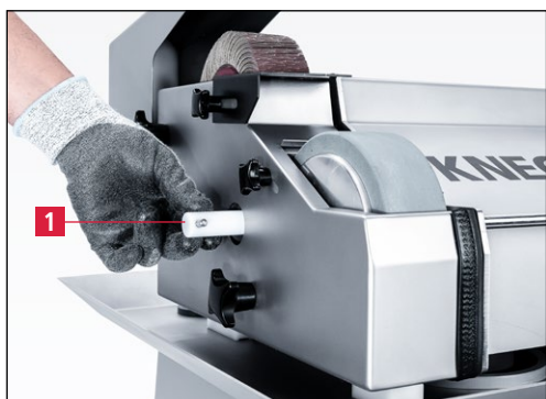
7-37. ábra A hűtőfolyadék-ellátás finombeállítás
