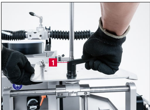
Rys. 9-18 Dokręcanie dźwigni szlifowania
