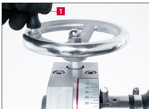
Rys. 7-24 Zmniejszanie kąta szlifowania (szlifowanie kulowe)
