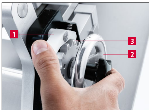
Rys. 9-20 Ustawianie urządzenia ostrzącego w pozycji szlifowania „1”
