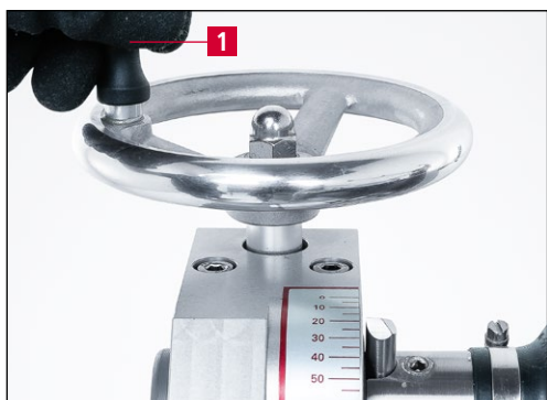
Rys. 7-48 Zmniejszanie kąta szlifowania (szlifowanie kulowe)
