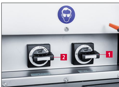
Rys. 7-22 Włączanie szlifierki i urządzenia chłodzącego
