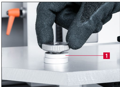
Rys. 9-4 Podkładki dystansowe regulacji kąta szlifowania
