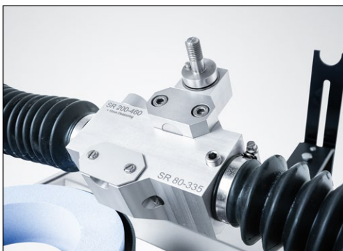
Rys. 7-28 Sprawdzenie położenia głowicy montażowej
