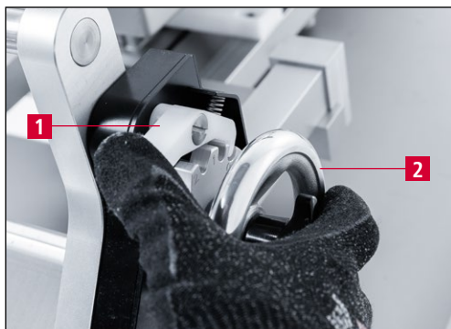
Rys. 9-13 Ustawianie urządzenia ostrzącego w pozycji ustawczej „0”
