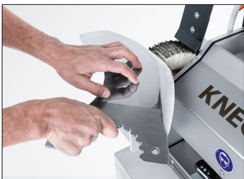
Rys. 9-50 Odgratowywanie i polerowanie noża kutrowego za pomocą ściernicy listkowej
