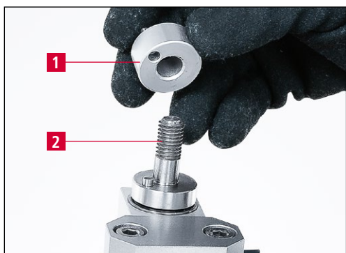
Rys. 7-33 Nakładanie podkładki dystansowej na trzpień mocujący
