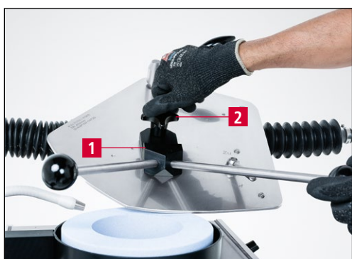
Rys. 7-37 Montaż dźwigni szlifowania na talerzu szlifierskim
