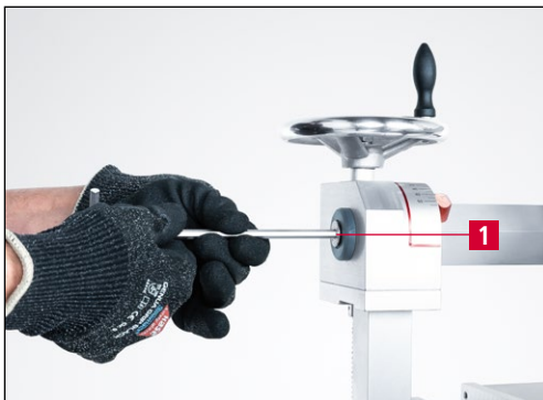
Rys. 6-1 Zdejmowanie ramienia obrotowego
