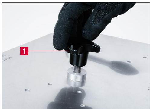
Rys. 7-36 Demontaż uchwyty krzyżowego
