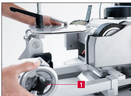
Rys. 9-24 Cofanie urządzenia ostrzającego
