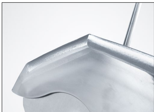
Rys. 7-26 Wstępnie oszlifowany kuliście nóż kutrowy
