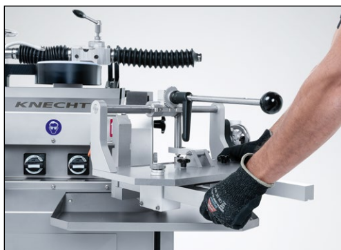
Rys. 8-2 Przesunięcie HV 262 do pozycji roboczej
