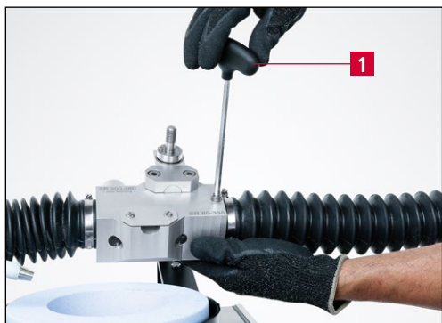
Rys. 7-29 Lekkie dokręcanie wózka prowadzącego
