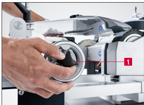
Rys. 9-48 Cofanie urządzenia ostrzowego
