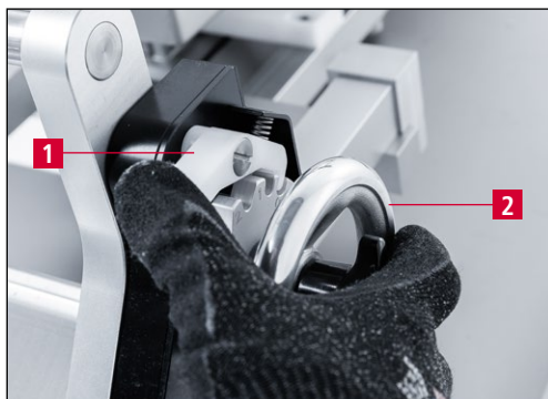
Rys. 9-40 Ustawianie urządzenia ostrzącego w pozycji ustawczej „0”
