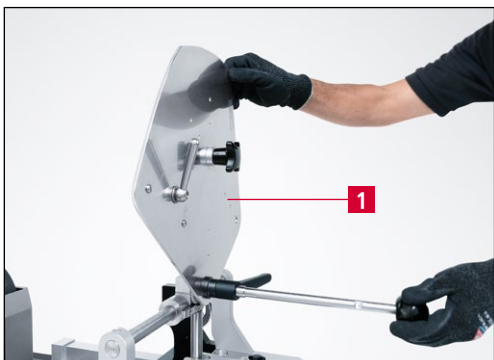
Rys. 9-35 Odchylenie talerza szlifierskiego do blokady przeciwbrotowej
