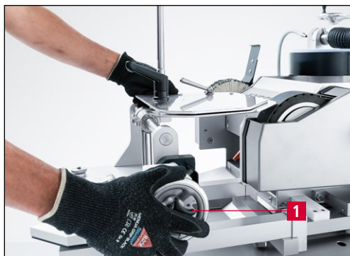
Rys. 9-15 Przesunięcie urządzenia ostrzącego do taśmy szlifierskiej
