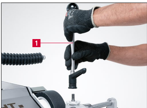
Rys. 9-2 Zdejmowanie dźwigni szlifierskiej
