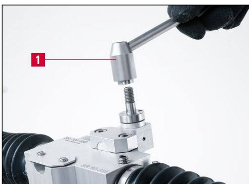
Rys. 7-4 Demontaż dźwigni zaciskowej
