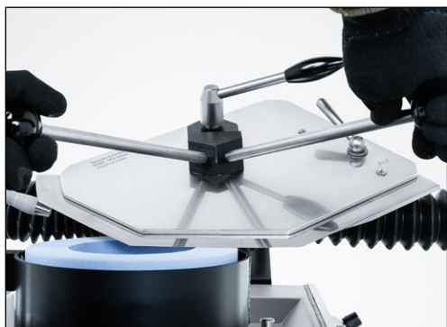
Rys. 7-15 Ustawianie noża na tarczy szlifierskiej
