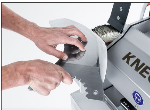
Rys. 9-26 Odgratowywanie i polerowanie noża kutrowego za pomocą ściernicy listkowej
