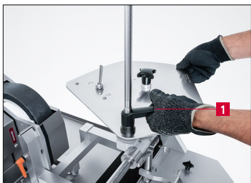
Rys. 9-33 Ustawianie zakresu odchylenia
