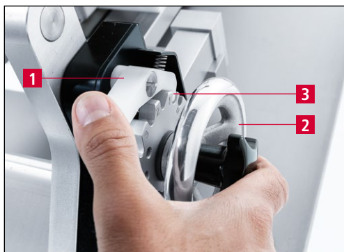
Rys. 9-44 Ustawianie urządzenia ostrzącego w pozycji szlifowania „1”
