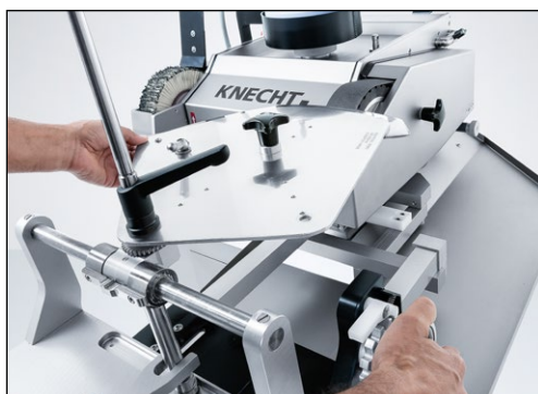
Rys. 9-42 Przesuwanie urządzenia ostrzącego do taśmy szlifierskiej
