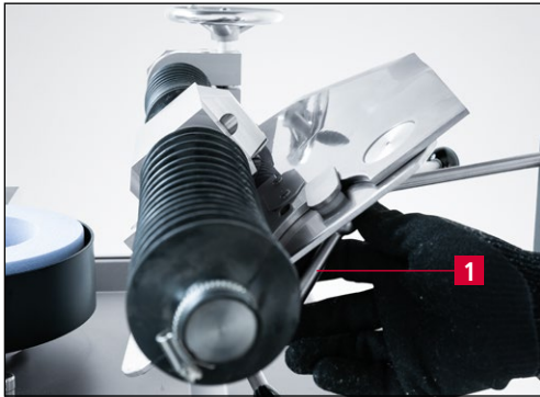
Rys. 7-10 Blokowanie noża na talerzu szlifierskim
