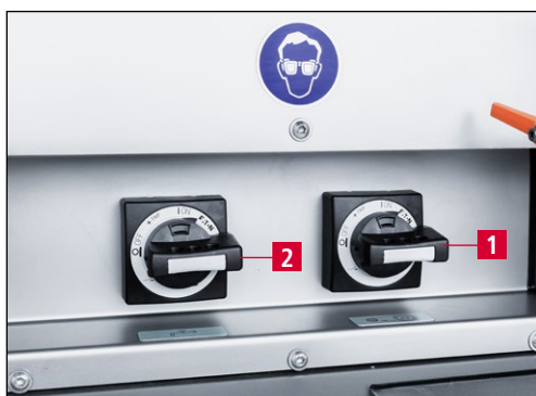
Rys. 7-19 Włączanie szlifierki i urządzenia chłodzącego
