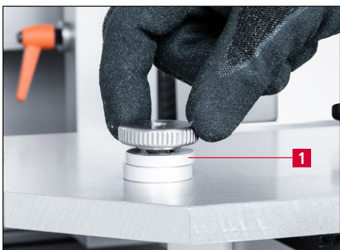
Rys. 9-29 Podkładki dystansowe regulacji kąta szlifowania
