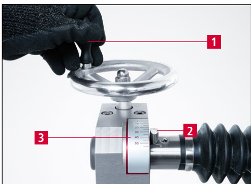
Rys. 7-18 Ustawianie kąta szlifowania
