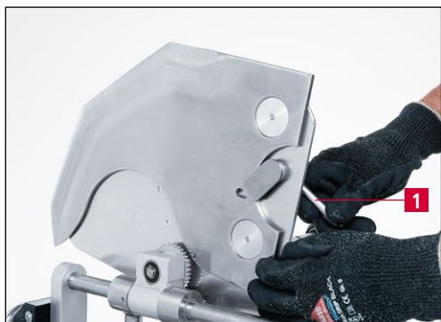
Rys. 9-10 Blokowanie noża na talerzu szlifierskim
