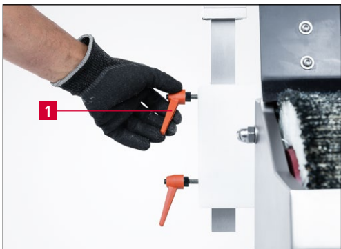
Rys. 7-17 Odkręcanie dźwigni zaciskowej
