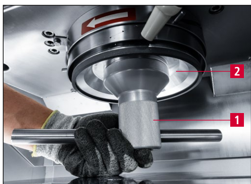
Rys. 7-8 Odkręcanie tarczy szlifierskiej
