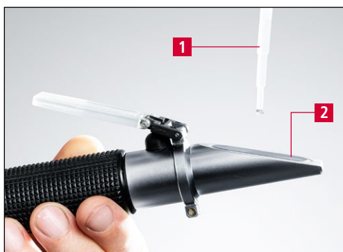
Rys. 9-11 Pomiar stężenia środka chłodząco-smarującego
