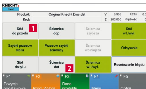
Rys. 8-15 Ustawianie stołu i ściernicy w pozycji roboczej
