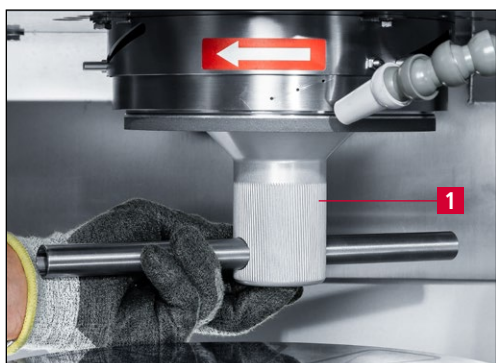
Rys. 7-9 Wymiana tarczy szlifierskiej
