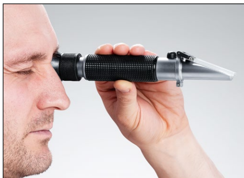
Rys. 9-12 Odczytywanie współczynnika załamania światła
