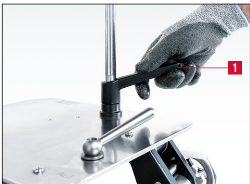
7-113. ábra A köszörűkar meglazítása
