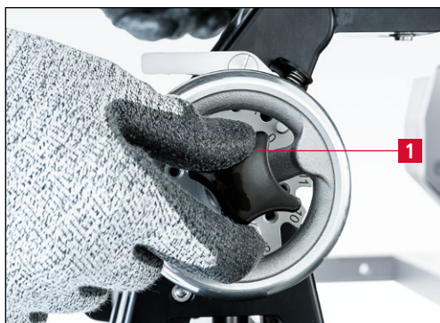
7-111. ábra A keresztfogantyú meglazítása
