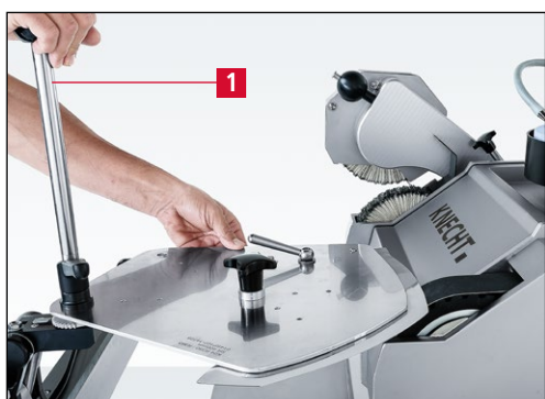
7-68. ábra Fordítsa a kutterkést a következő vágási szegmenshez és köszörülje meg
