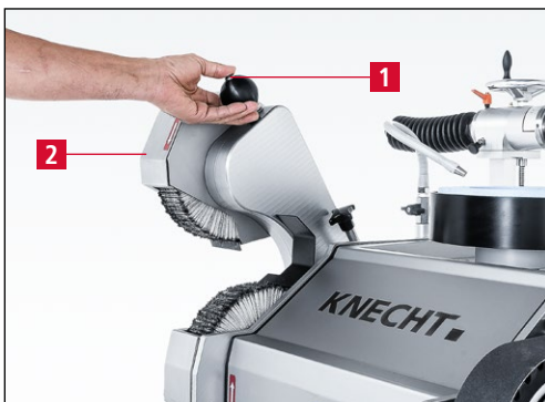
7-137. ábra A felső polírozóegység nyugalmi pozícióba állítása
