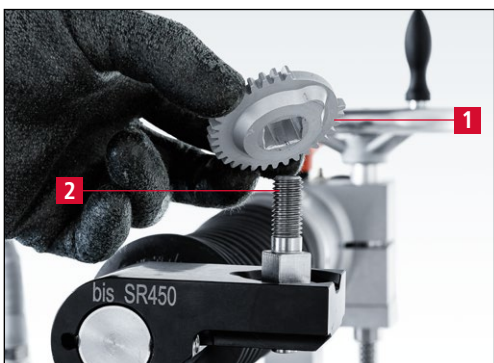
7-7. ábra Működtetőtárcsa behelyezése
