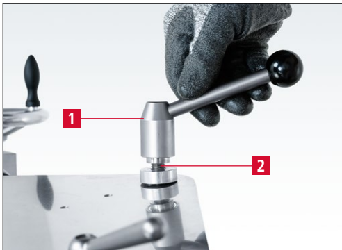
7-12. ábra A köszörűlemez rögzítése
