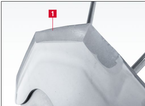
7-93. ábra Domborúra előkészített kutterkés
