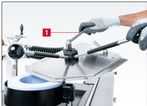
7-84. ábra A feszítőkar meglazítása
