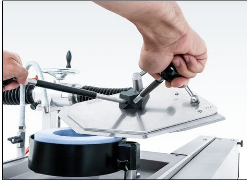
7-92. ábra Fordítsa a kutterkést a következő vágási szegmenshez és köszörülje meg
