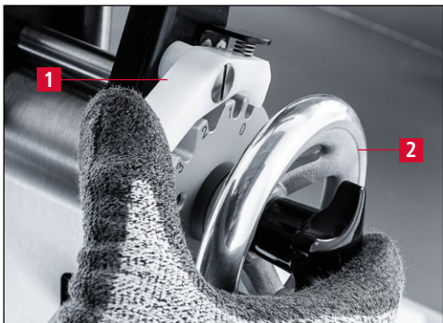
7-45. ábra A köszörőberendezés „0”-ás a beállítási pozícióba állítása
