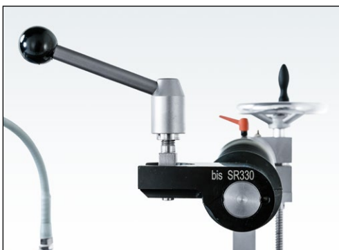
7-69. ábra A befogófej helyzetének ellenőrzése
