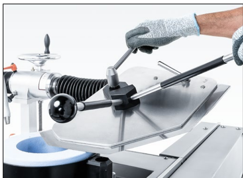
7-85. ábra A kés beigazítása a köszörűkorongon
