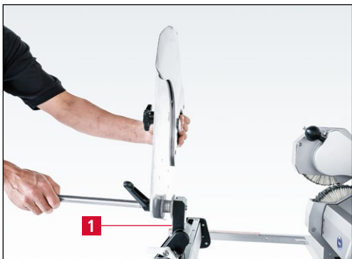
7-52. ábra A kutterkés visszahajtvá és biztosítva
