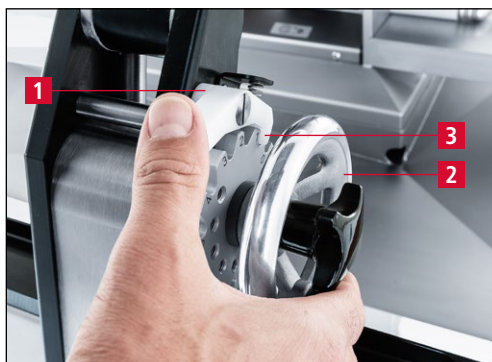
7-49. ábra A köszörűberendezés „1”-es köszörülési pozícióba állítása
