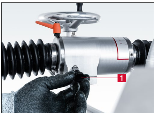
7-6. ábra A reteszelőcsap bepattintása a helyére
