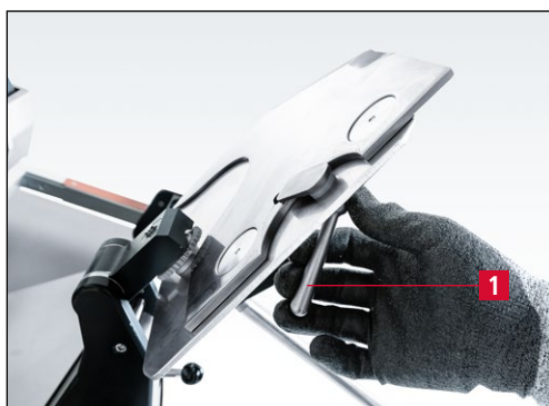
7-107. ábra A kés reteszelése a köszörűlemezen
