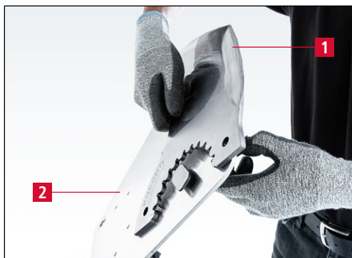
7-41. ábra A kés felfogatása a köszörűlemezre
