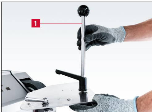
7-104. ábra A köszörőlemez megfeszítése
