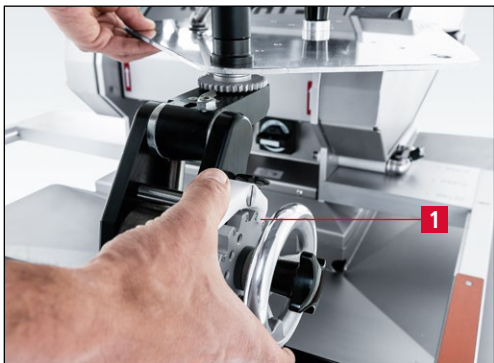
7-51. ábra A sarlóformájú kutterkés domborúra köszörülése
