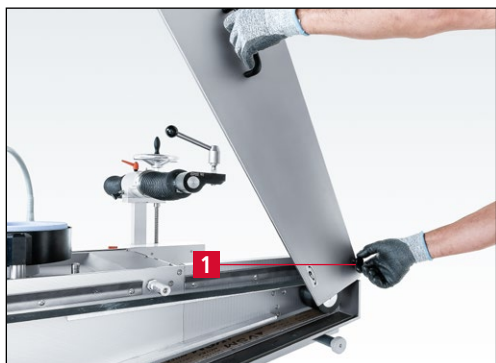
7-149. ábra A szalag védőburkolatának zárása
