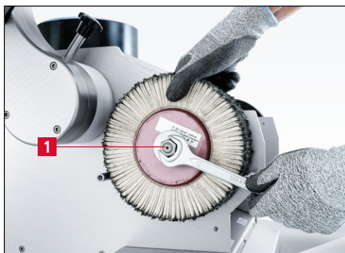
7-152. ábra Az alsó lamellás kefék cseréje
