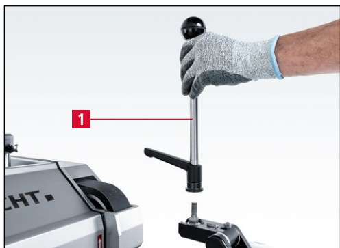
7-99. ábra A köszörűkar eltávolítása
