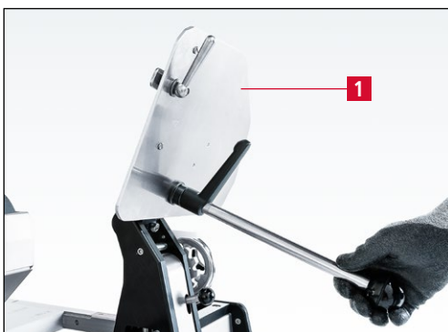
7-105. ábra A köszörőlemez hátrafele fordítása
