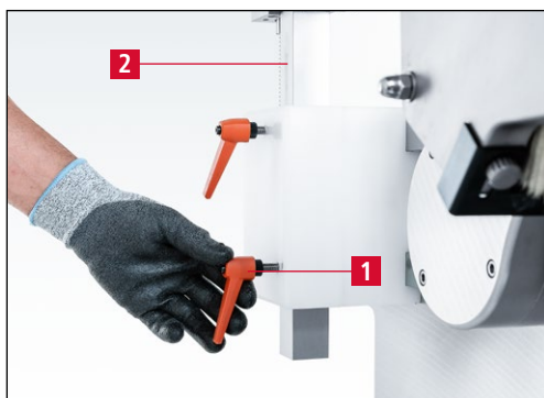
7-83. ábra A kés beállítása a köszörűkorong középpontjába
