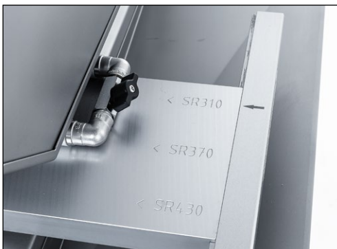
7-94. ábra A köszörülő- és polírozóberendezés beállított helyzete
