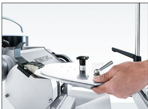
7-62. ábra A kés domborulatának polírozása
