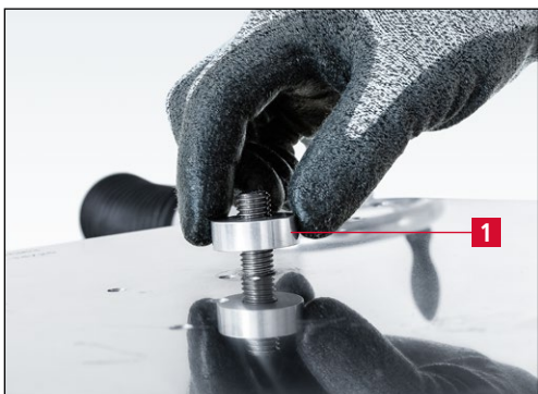
7-10. ábra A távtartó korong eltávolítása
