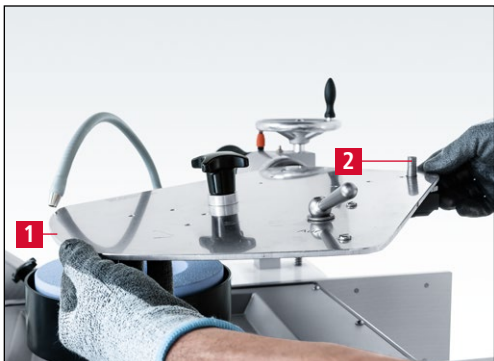
7-8. ábra A köszörűlemez felszerelése
