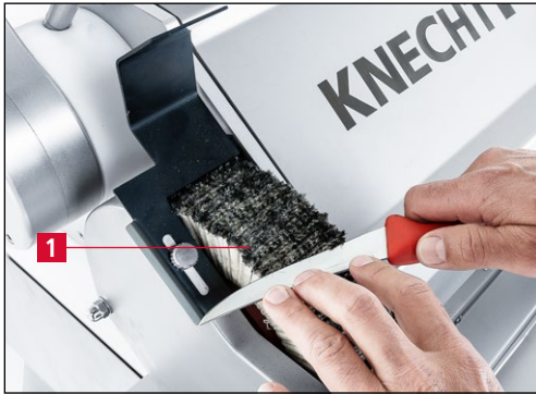
7-138. ábra A kézi vágókések sorjátlanítása és polírozása
