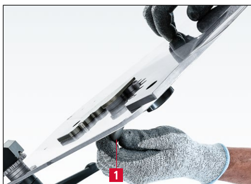
7-42. ábra A kés reteszelve a köszörűlemezen
