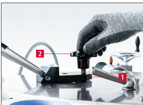
7-13. ábra A köszörűkar felszerelése a köszörűlemeze
