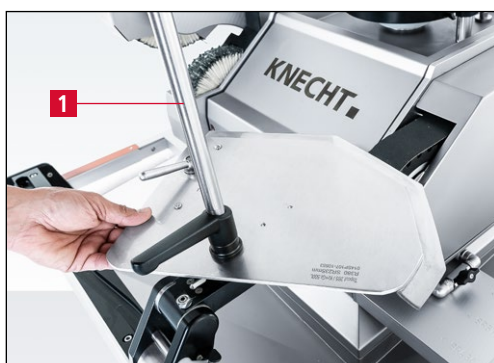
7-135. ábra A kutterkés következő vágási szegmenshez fordítása és köszörülése
