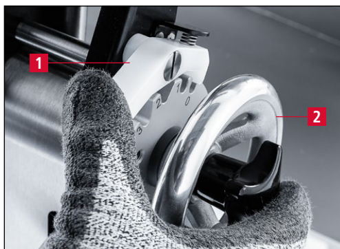
7-110. ábra A köszörűberendezés „0”-ás a beállítási pozícióba állítása
