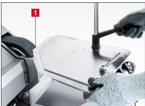
7-114. ábra A kés beigazítása a csiszolószalagon
