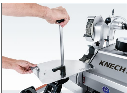
7-129. ábra A kés domborulatának polírozása
