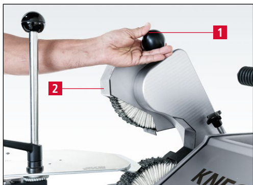
7-127. ábra A felső polírozóegység felfelé fordítása
