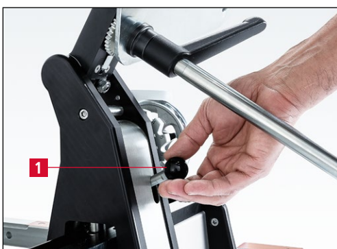
7-56. ábra A vezető kocsin lévő reteszelés kioldása
