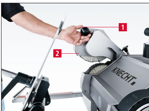
7-131. ábra A felső polírozóegység munkapozícióba állítása
