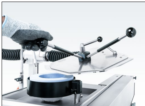
7-81. ábra A köszörűlemez előrefele fordítása
