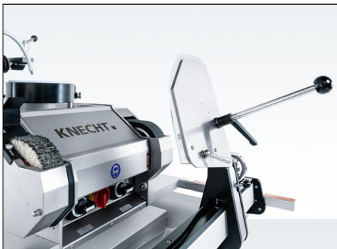
7-130. ábra Kés a polírozási területen kívül, rögzített helyzetben
