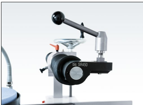
7-1. ábra A befogófej helyzetének ellenőrzése
