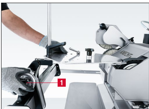
7-47. ábra A köszörőberendezés csiszolósza-laghoz mozgatása
