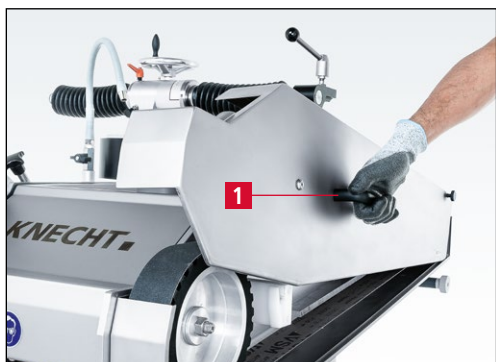
7-146. ábra A szalag védőburkolatának nyitása
