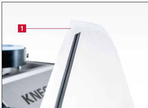
7-134. ábra A kés élességének ellenőrzése
