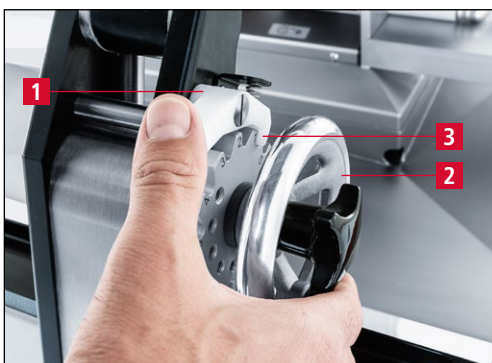
7-117. ábra A köszörűberendezés „1”-es köszörülési pozícióba állítása
