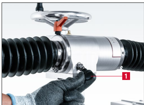
7-73. ábra A reteszelőcsap bepattintása a helyére
