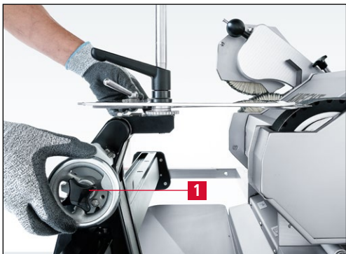
7-112. ábra A köszörűberendezés csiszolószalaghoz mozgatása
