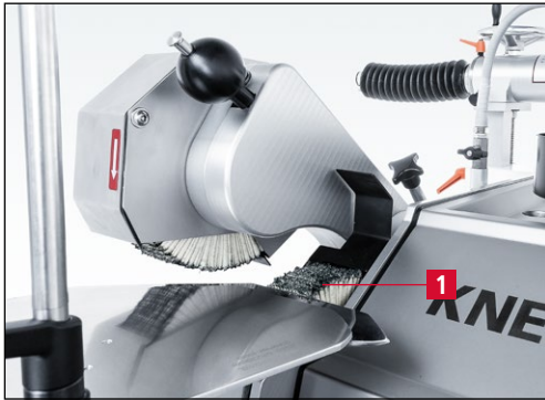
7-124. ábra A kés a lamellás kefén fekszik
