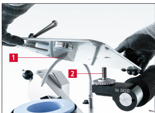
7-75. ábra A köszörűlemez felszerelése
