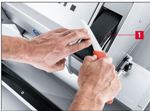
7-136. ábra A kézi vágókések köszörülése
