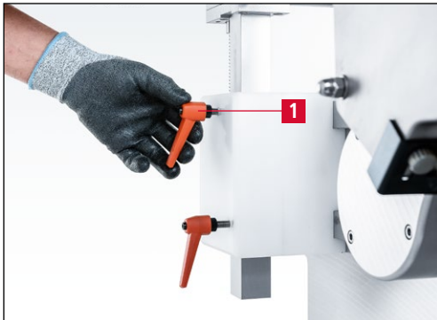
7-87. ábra A szorítókar meglazítása
