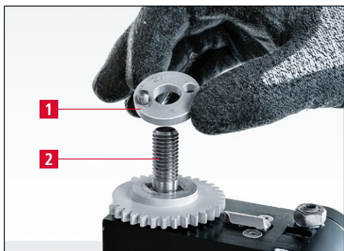
7-36. ábra A köszörülési szög beállítása
