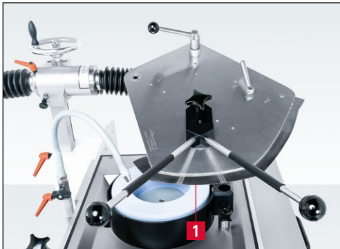
7-19. ábra A kés helyzete a köszörűkorongon
