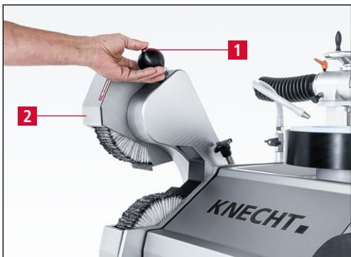
7-64. ábra A felső polírozóegység munkapozícióba állítása
