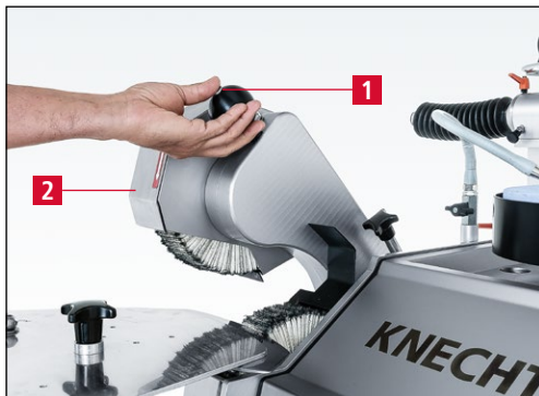
7-60. ábra A felső polírozóegység felfelé fordítása
