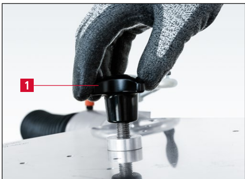
7-9. ábra A keresztfogantyú eltávolítása
