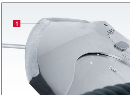
7-27. ábra Domborúra előkészített kutterkés
