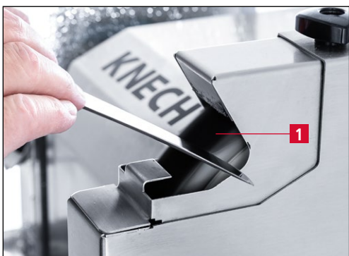
Slika 7-6 Poliranje ručnog noža
