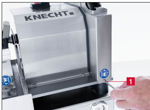
Slika 7-13 Otpuštanje pokrova ploče za poliranje
