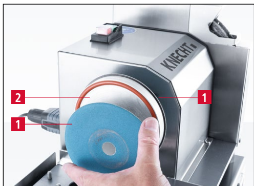
Slika 7-10 Uklanjanje istrošenih ploča za poliranje
