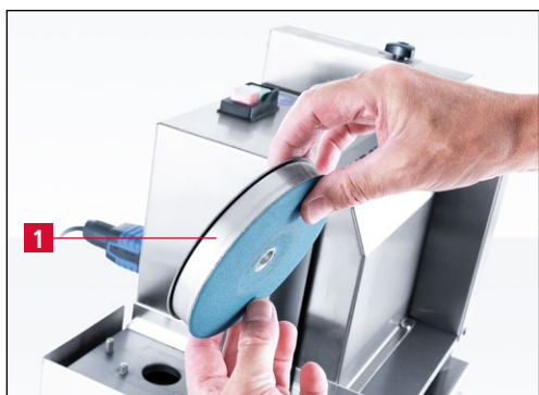
Slika 7-11 Montaža para novih ploča za poliranje
