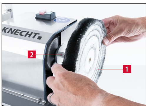
Slika 7-16 Zamjena ploče za poliranje
