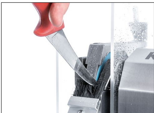
Slika 7-4 Brušenje ručnog noža
