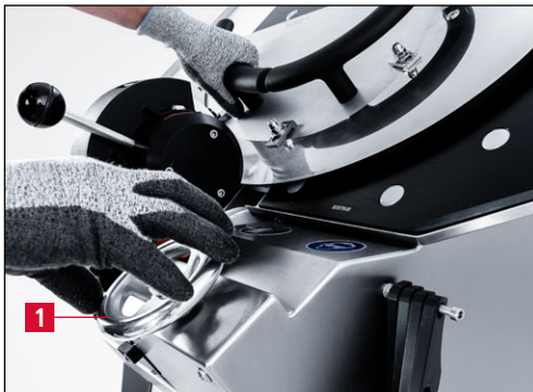
Bild 7-10 Schleifaggregat in die untere Endlage bewegen
