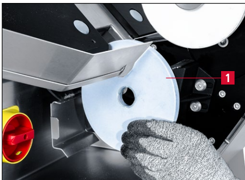
Bild 7-50 Schleifscheiben abnehmen und durch neue ersetzen
