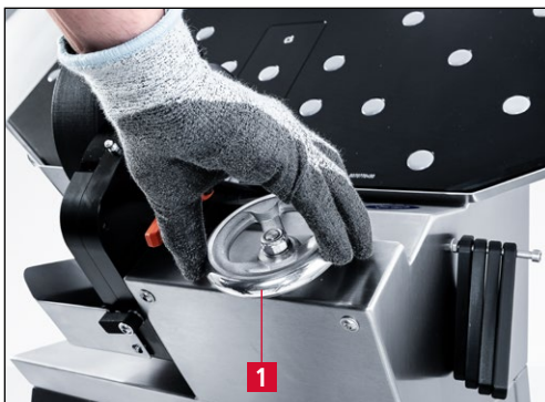
Bild 7-41 Schleifaggregat in die obere Endlage bewegen
