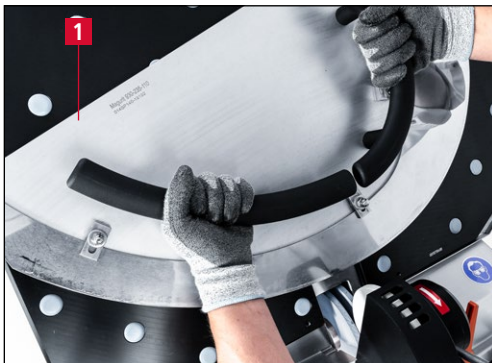
Bild 7-18 Sichelmesser nach oben schieben
