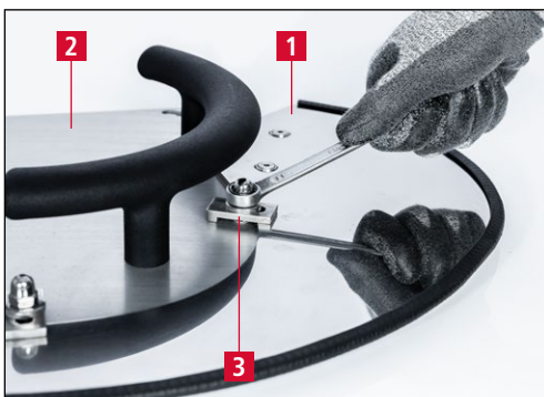
Bild 7-3 Sichelmesser auf Kopierschleifplatte spannen
