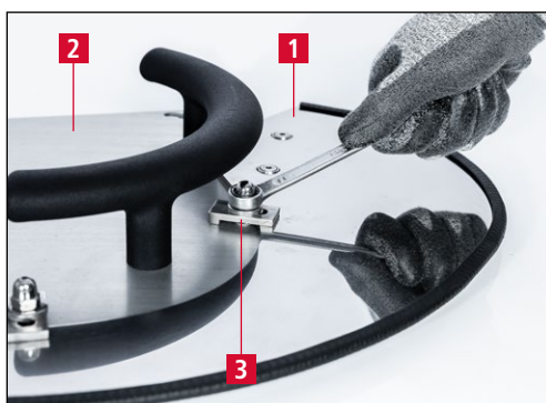
Bild 7-3 Sichelmesser auf Kopierschleifplatte spannen
