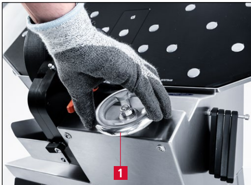
Bild 6-1 Schleifaggregat in obere Endlage bewegen
