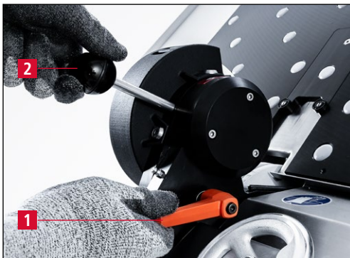
Bild 7-30 Entgrataggregat in obere Endlage bewegen
