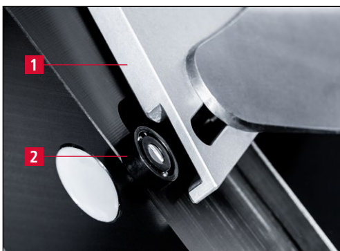
Bild 7-6 Kopierschleifplatte mit Messer auf Schleiftisch montieren
