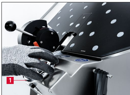
Bild 7-29 Schleifaggregat in mittlere Position bewegen
