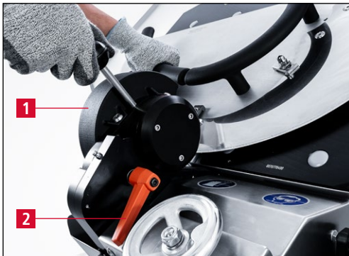
Bild 7-17 Entgratscheibe in Schleifposition bringen
