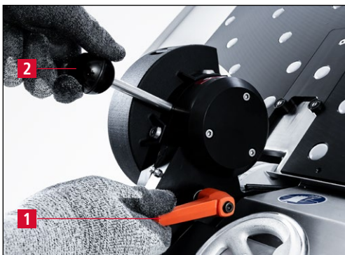
Bild 7-5 Entgrateinheit in die obere Endlage schwenken
