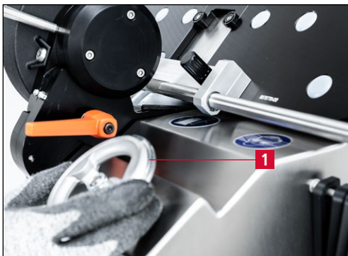
Bild 7-33 Schleifaggregat in Abrichtposition bewegen
