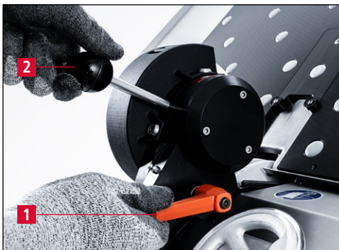
Bild 7-11 Entgrateinheit in die obere Endlage schwenken
